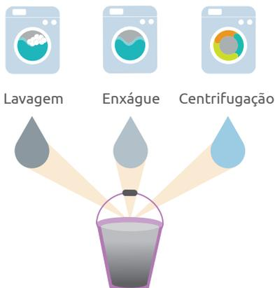
Coleta de todas as descargas da lavadora em um mesmo recipiente. A cor da água coletada pode variar do cinza claro ao escuro. Os usos são restritos; não será possível, por exemplo, reutilizar a água na máquina de lavar.
