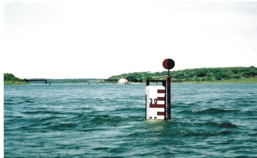
Régua de medição do nível d'água
