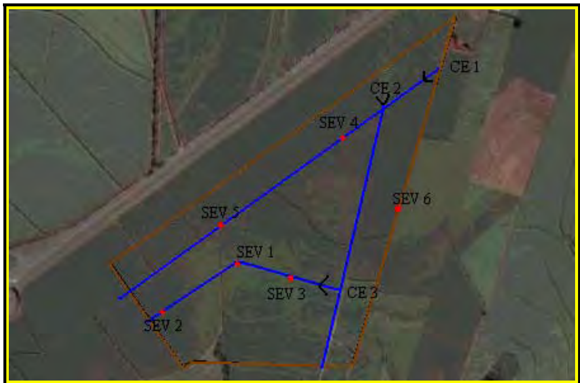
Figura 20: Localização aproximada dos levantamentos geofísicos, a partir de imagem aérea obtida do programa Google Earth. As setas indicam o sentido dos caminhamentos executados (CE).
