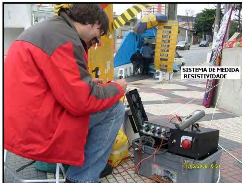
Figura 19: Sistema para medida de resistividade, composto por uma fonte de tensão conjugada a um sistema de comutação de eletrodos.
