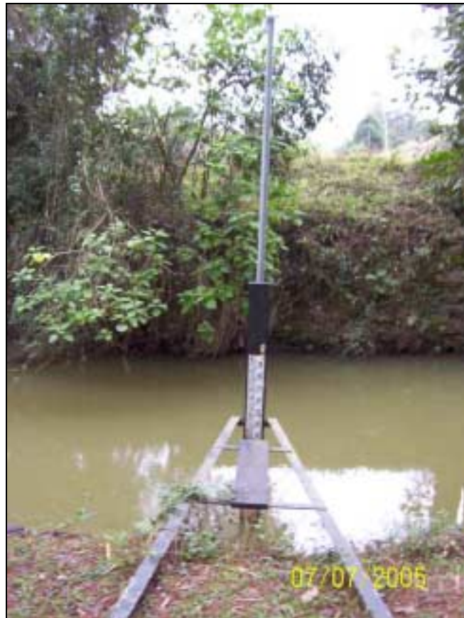
Figura 3.35 - Duto de Sensor de Nível do Posto Piracaia
