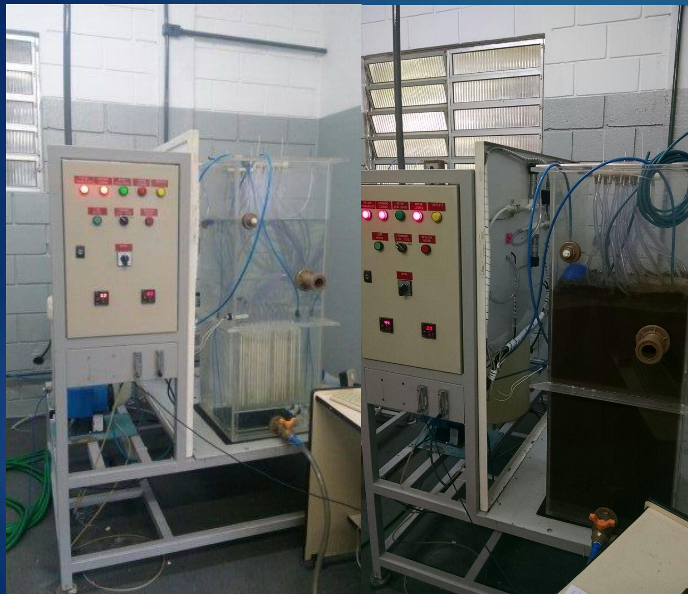
Unidade Piloto com Membranas Modificadas e Comerciais (antes e depois o início da operação com esgoto)
