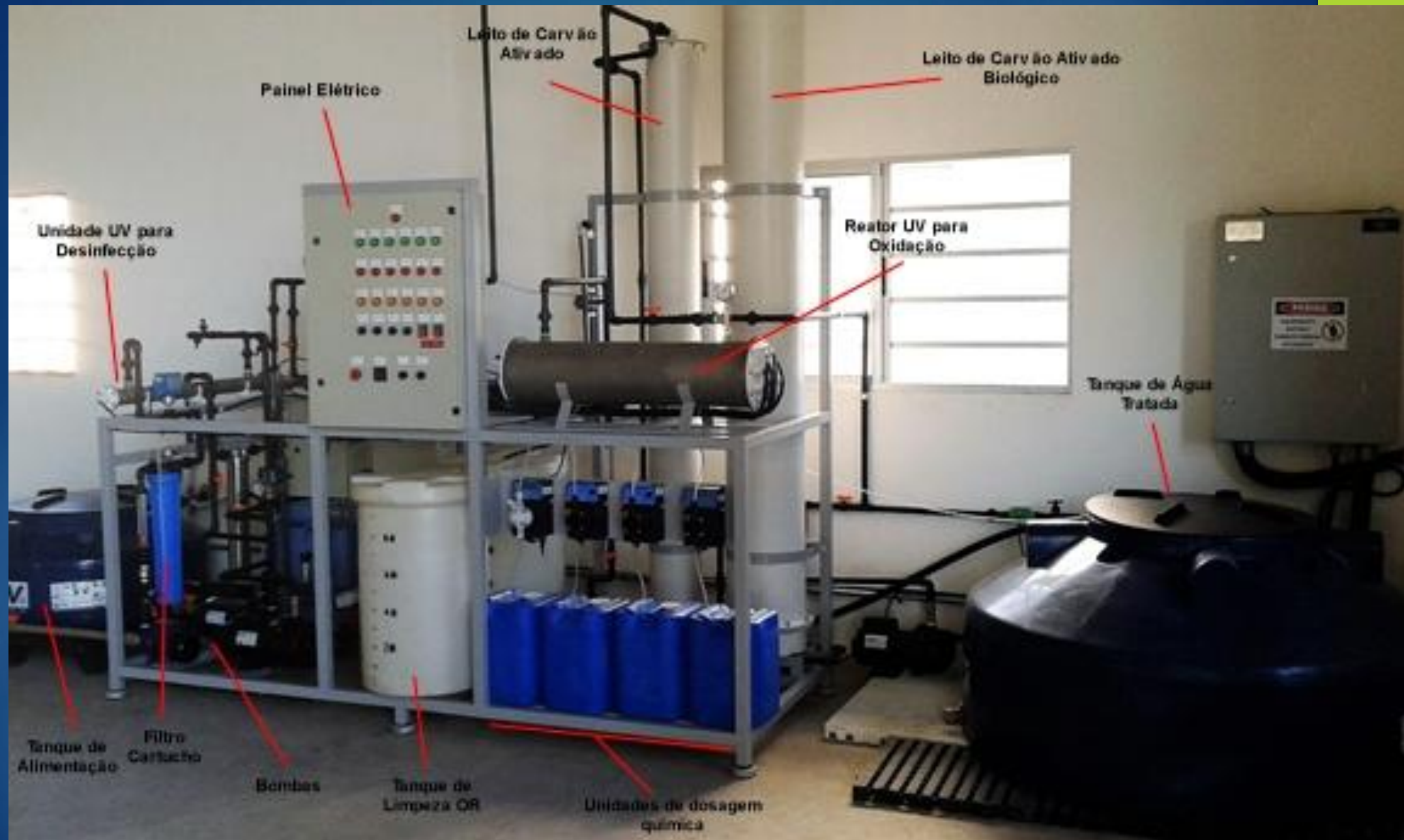
Imagem da Unidade Piloto para Produção de Água de Reúso Potável
