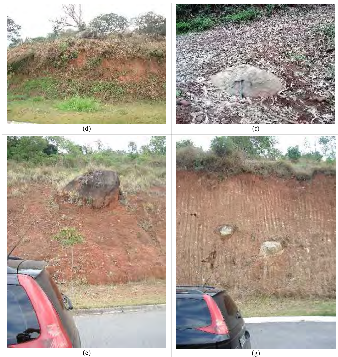
Foto 35: Fotos “d”, “e”, “f” e “g” - Ocorrências de blocos rochosos em meio ao solo residual. Observar a diversidade de modos de ocorrência, podendo os blocos estarem na superfície do terreno natural, no interior do perfil de alteração ou mesmo na superfície de estradas ou trilhas, podendo dificultar os trabalhos de fundação e terraplanagem.
