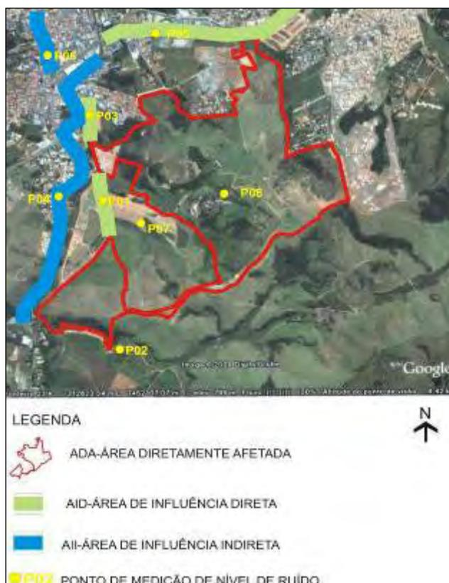
Figura 4.1.3.4-1: Delimitação das áreas de Influência e os pontos de medição dos níveis de ruído correspondente.
