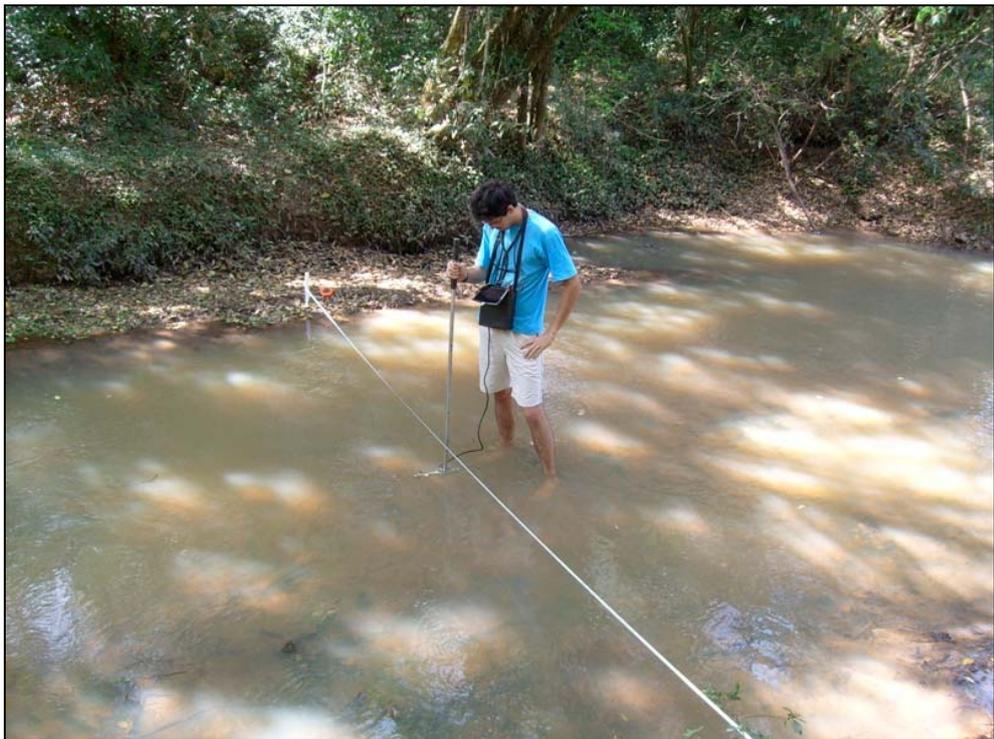
Foto 1: Medição de vazão com molinete hidrométrico na cabeceira da simulação.(27/08/2008)
