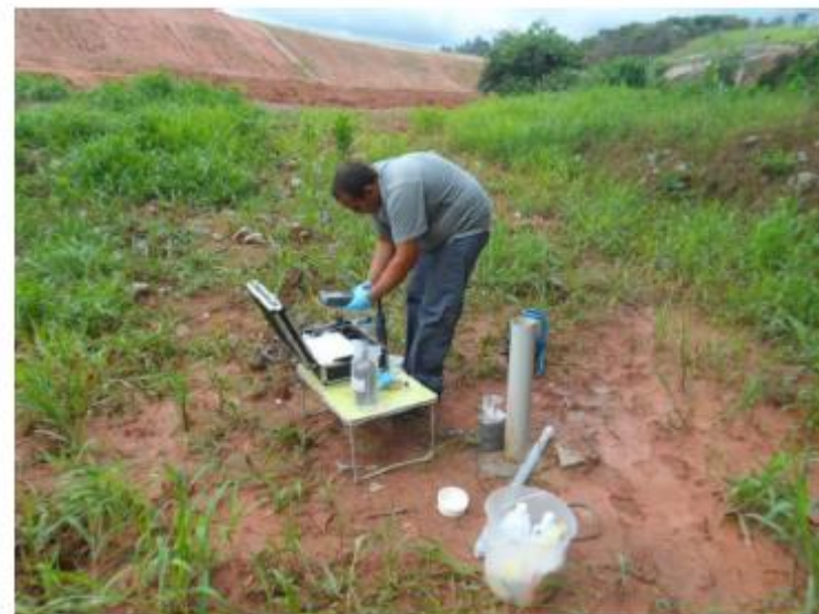
Foto 17: Realização de leitura dos parâmetros físico-químicos durante a realização da amostragem de água subterrânea.
