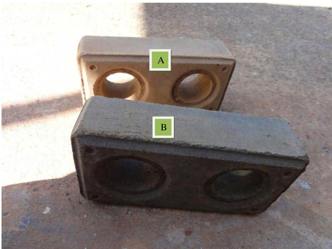
**Figura 5.5.1.6: (A) Bloco cerâmico sem a adição de lodo e (B) com adição de lodo de ETA.**
