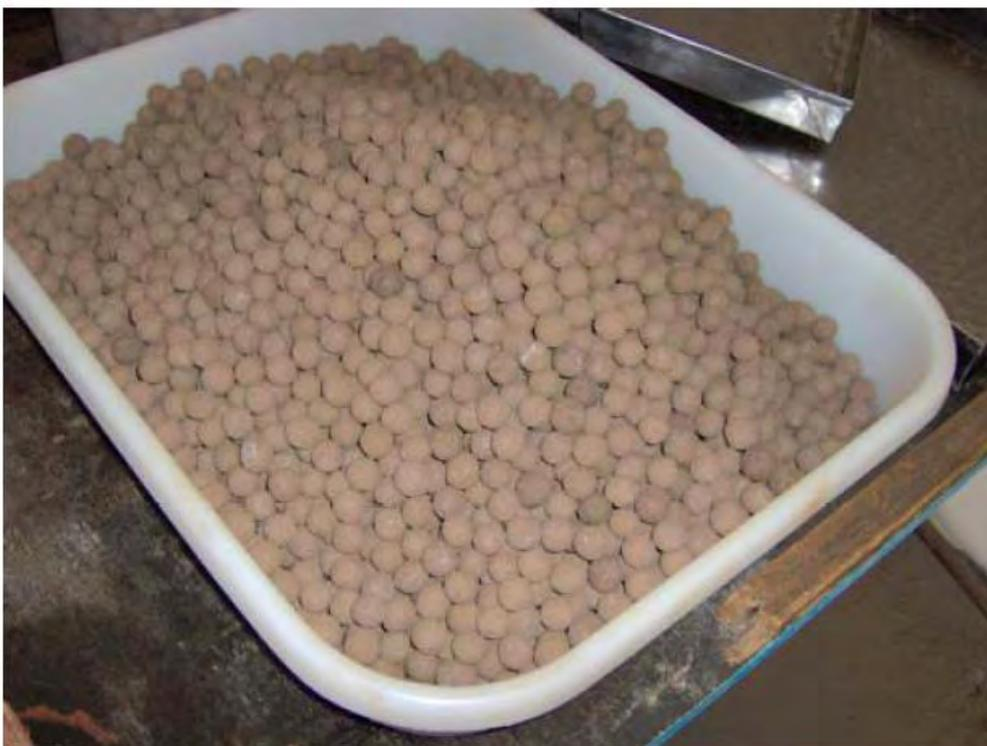
**Figura 5.6. 3 - Compósito com lodo de ETA e serragem de madeira.**
