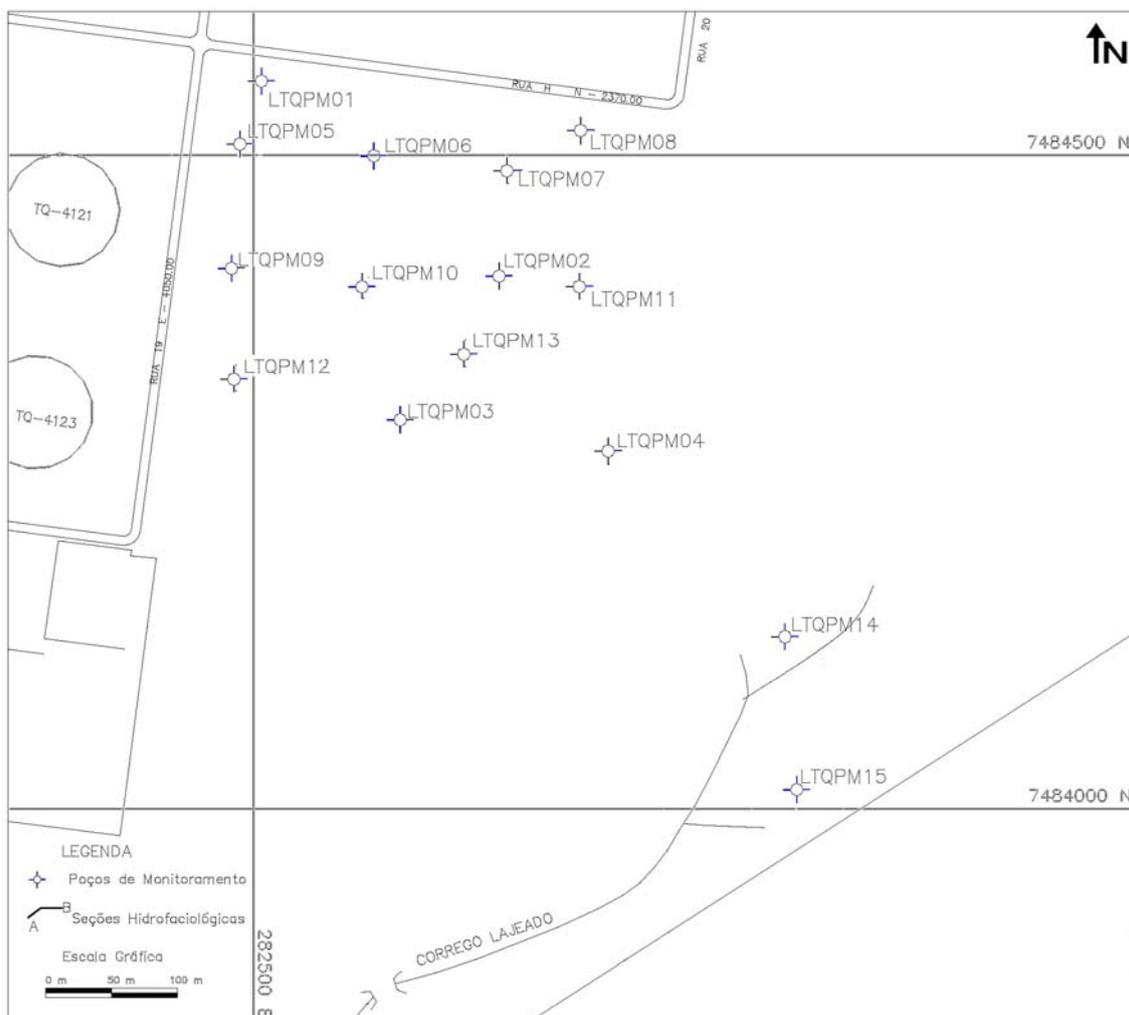
Figura nº 171 – Localização dos poços de monitoramento na área leste do Tanque 4123
