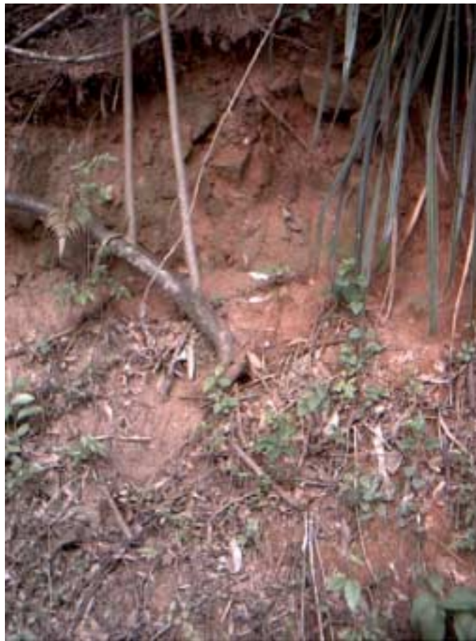
Foto 5.2.2-7 – Perfil de solo coluvionar, com linha de pedras sobre gnaisses xistosos, na porção norte do traçado da nova via.
