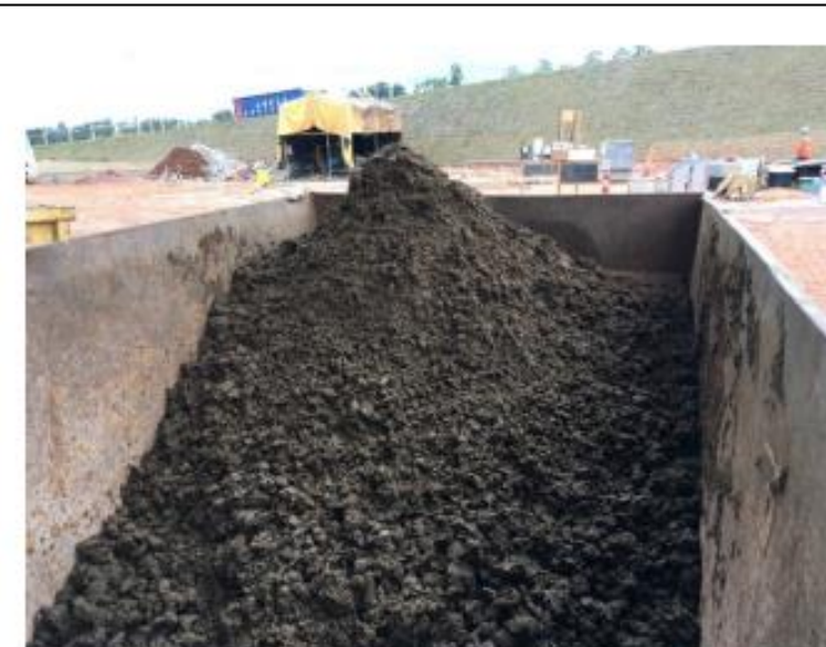
Caçamba de armazenamento de lodo desaguado, após o sistema BS-COMBI
