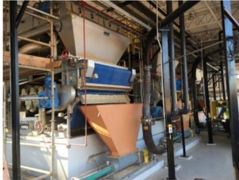
Saída do BS-Combi, com destaque para a bomba de transporte de lodo desaguado da Netzsch
