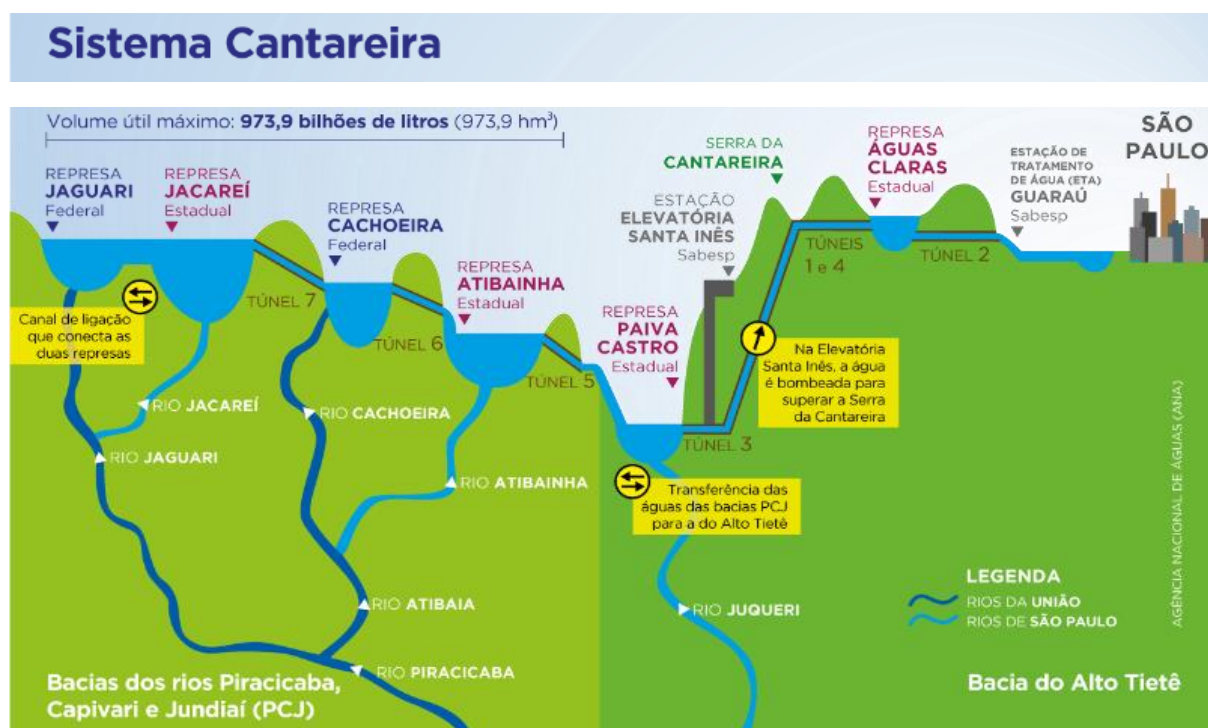
Figura 2.6 – Esquemático do funcionamento do Sistema Cantareira.
