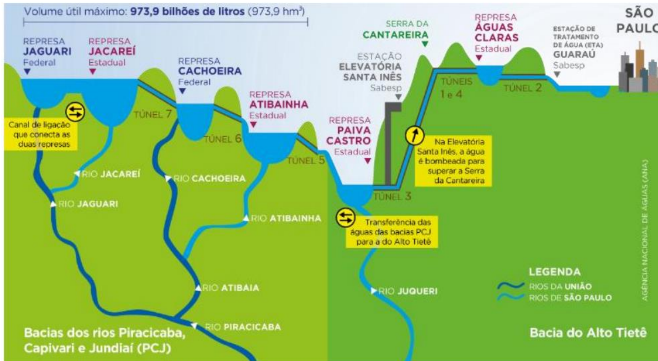
Figura 2.6 – Esquemático do funcionamento do Sistema Cantareira.
