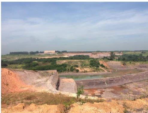
Bancadas de extração de argila.
