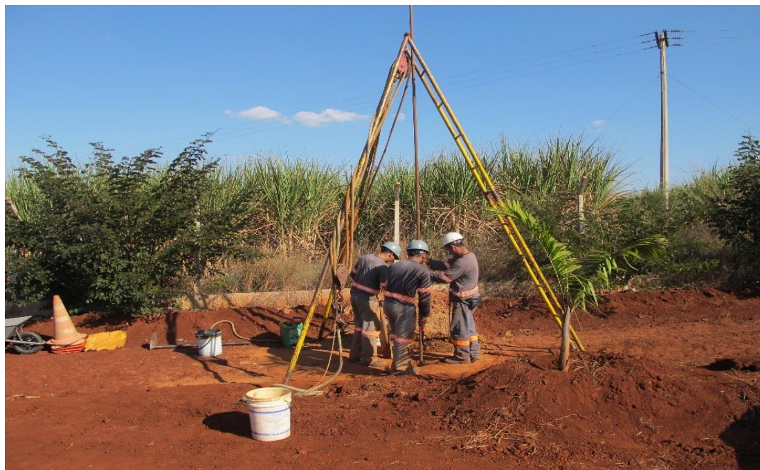
Figura 7.2.5.2-4: Sondagem com trado manual e sem lama de perfuração (PM-04)
