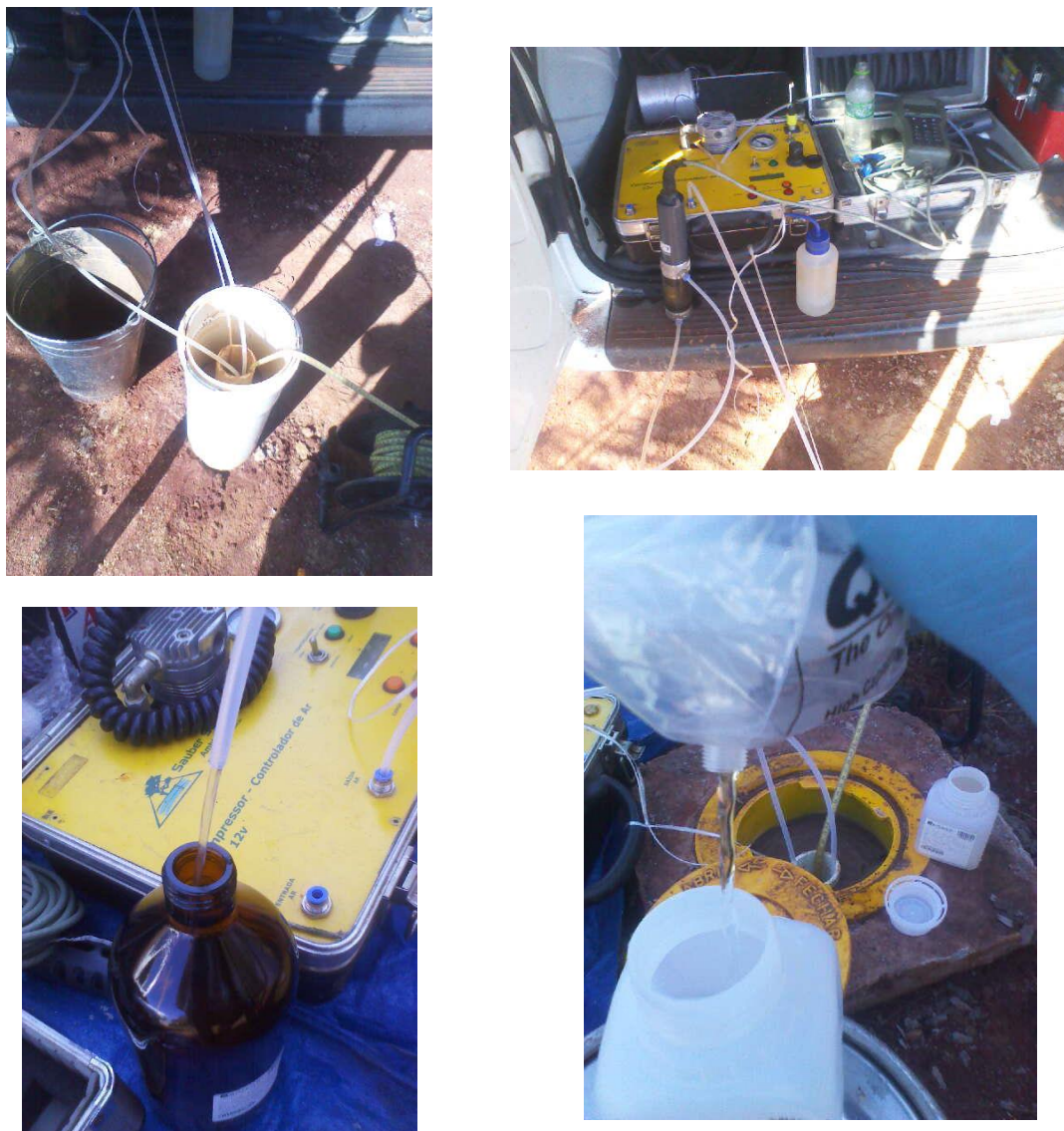
Figura 7.2.5.2-5 - Amostragem no PM-02 e PM-04 pelo método de baixa vazão
