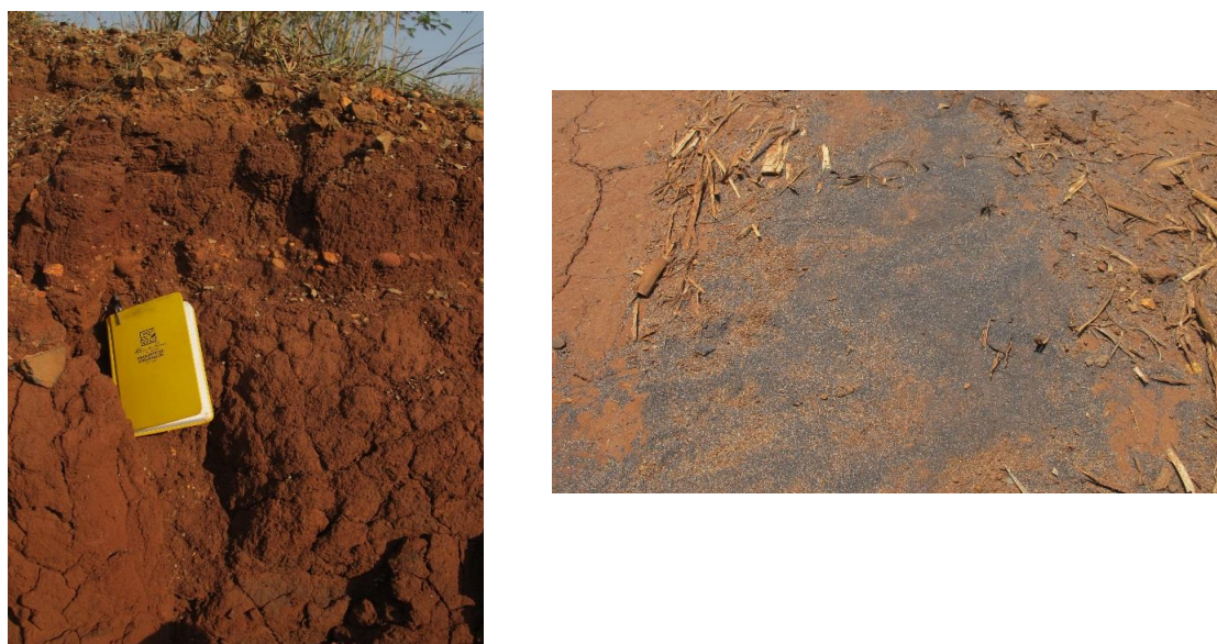
Figura 7.2.4.4-4: Foto esquerda, Horizonte de solo transportando sobre o Horizonte B latossólico, ponto Ped6. Foto direita, minerais ferro-magnesianos pretéritos da lixiviação das rochas básicas da Formação Serra Geral e posteriormente do latossolo, ponto Ped2.
