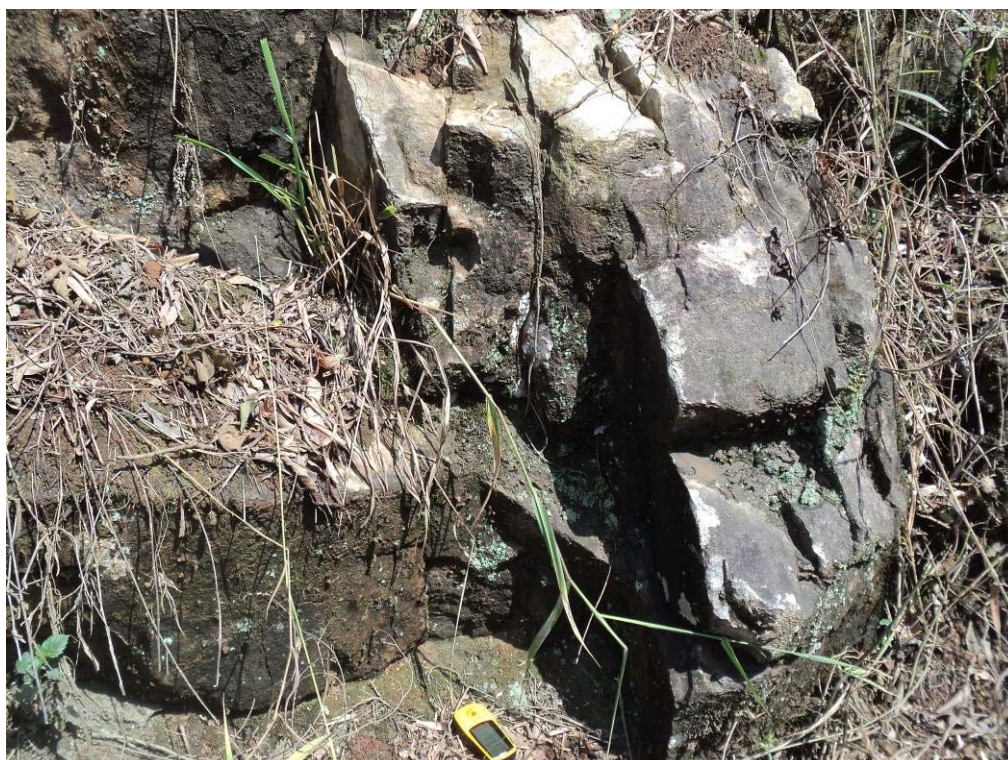
Foto 2 - Biotita gnaiss fino, com fraturas lisas, verticais e inclinadas, com espaçamento de 20 a 40 cm, abertura menor que 1 mm (rocha sã a levemente alterada, medianamente fraturada)
