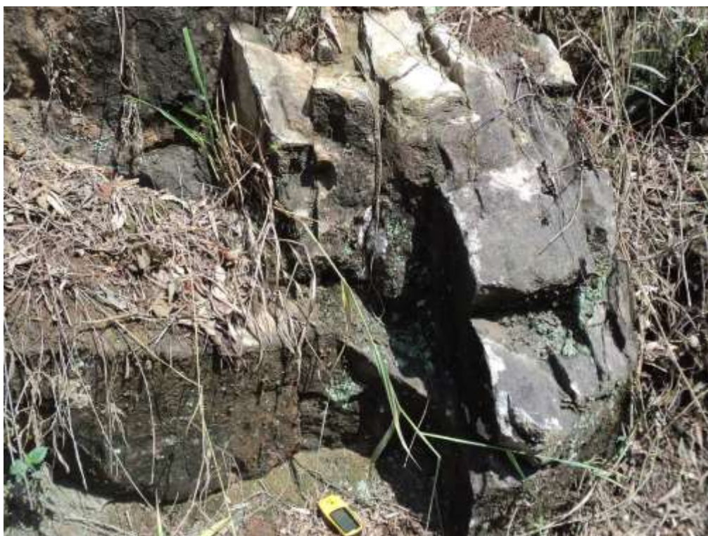
Foto 4: Biotita gnaiss fino, com fraturas lisas, verticais e inclinadas, com espaçamento de 20 a 40 cm, abertura menor que 1 mm. (Rocha sã a levemente alterada, medianamente fraturada).
