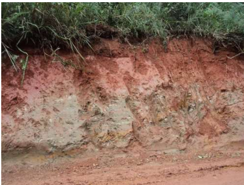
Foto 5: Solo residual maduro e solo residual jovem. Silte argilo-arenoso.
