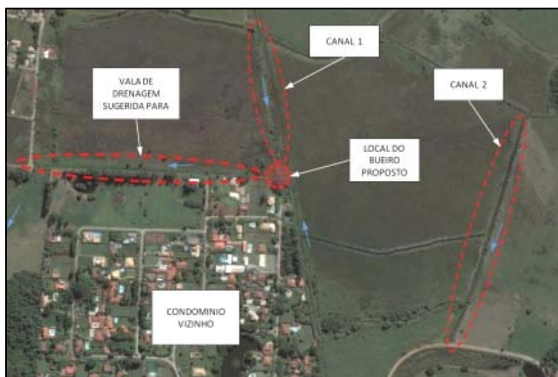
FIGURA 2.4-3: Indicação da vala de drenagem proposta para adequação da seção de escoamento e ponto indicado para implantação de bueiro.
