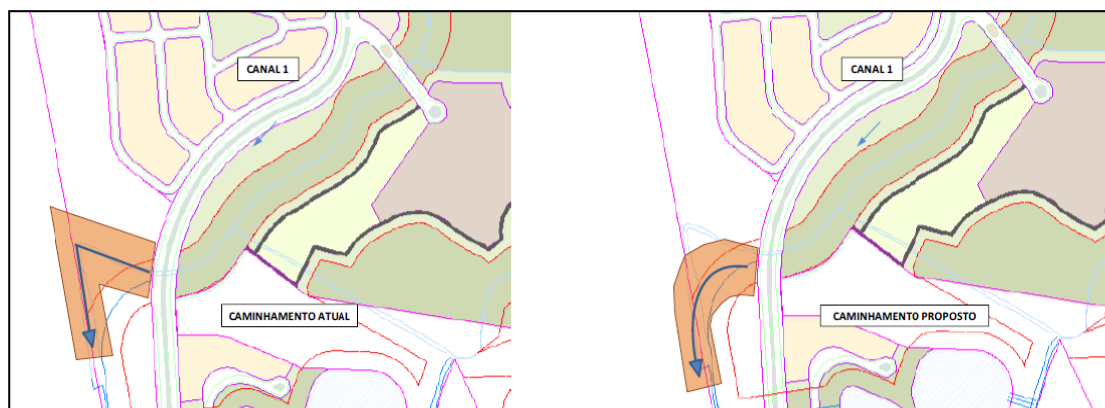
FIGURA 2.4.-2: Readequação proposta para o canal 1.
