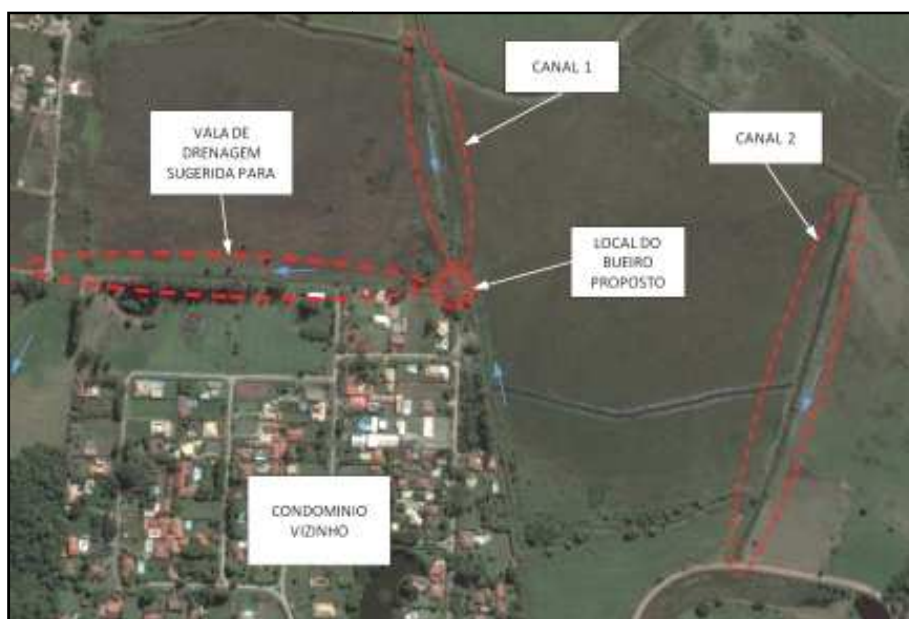
FIGURA 2.2.2.2-8: Indicação da vala de drenagem proposta para adequação da seção de escoamento. Indicação do local sugerido para implantação de bueiro.
