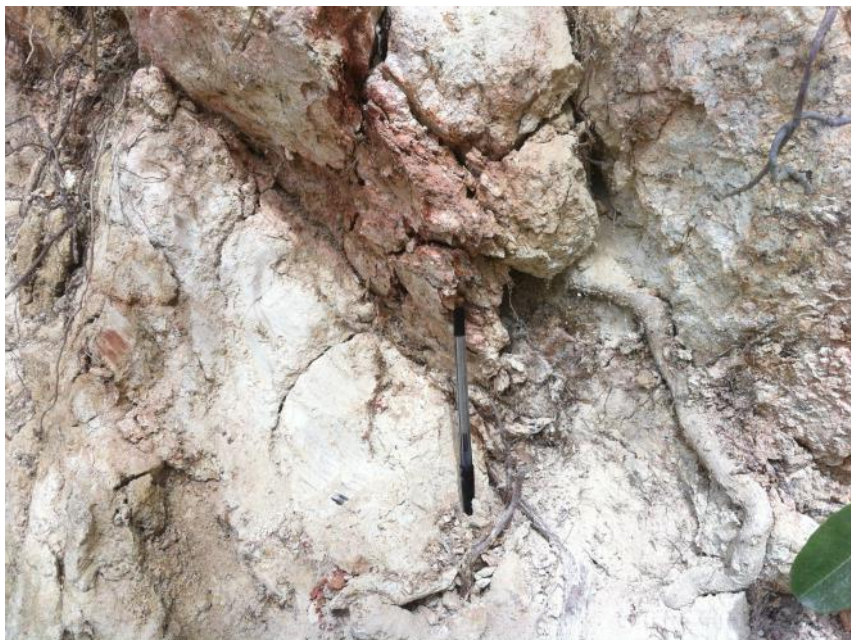
Foto 9: Detalhe de saprolito de gnaiss parental com intensa caulnização, nas proximidades da Fazenda Chapéu-de-sol.
