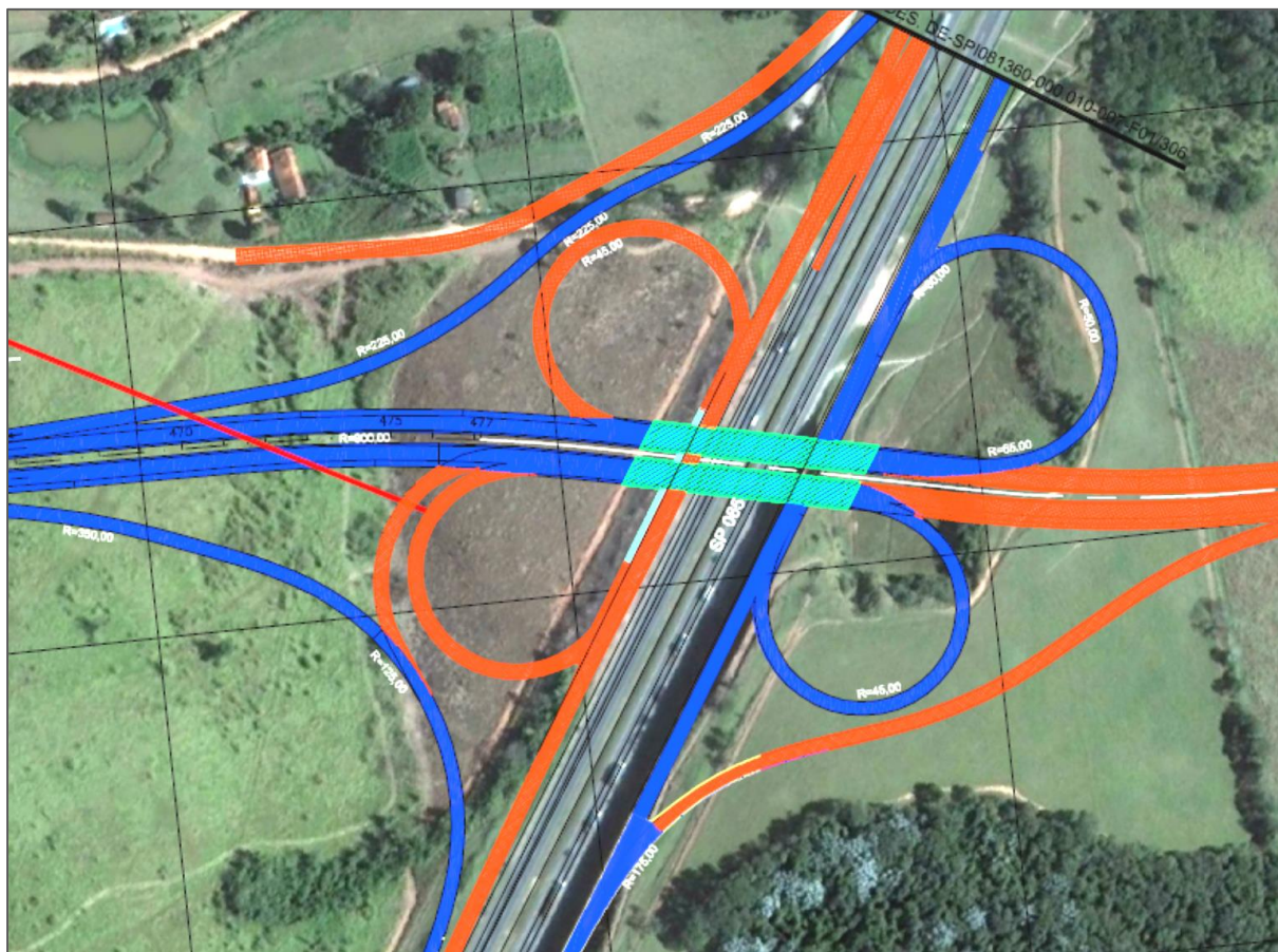
Figura 7.2.3-2: Ilustração do dispositivo de entroncamento da Perimetral com a Dom Pedro I (formato de trevo completo).
