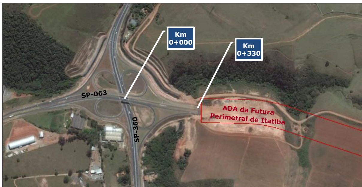
Figura 8.3-1: Ilustração do atual dispositivo de entroncamento entre as Rodovias SP-063 e SP-360, já preparado para a saída da Perimetral de Itatiba.
