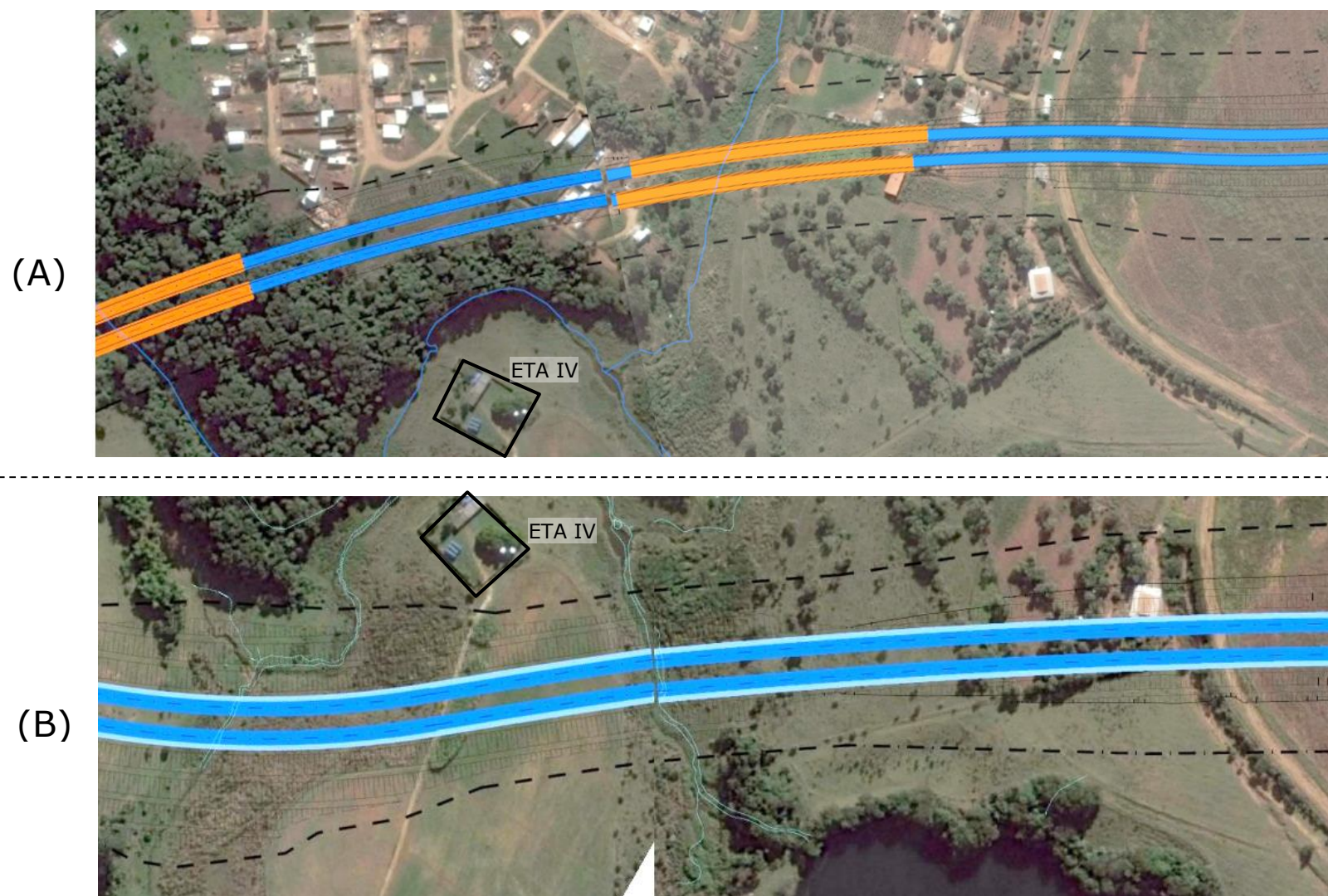
Figura 3.1.2-8: Alternativas locacionais na proximidade com a ETA IV: (A) traçado deslocado para o norte, desviando da captação e afetando porção do bairro; (B) traçado deslocado para o sul, interceptando o meandro do Rio Capivari-Mirim.
