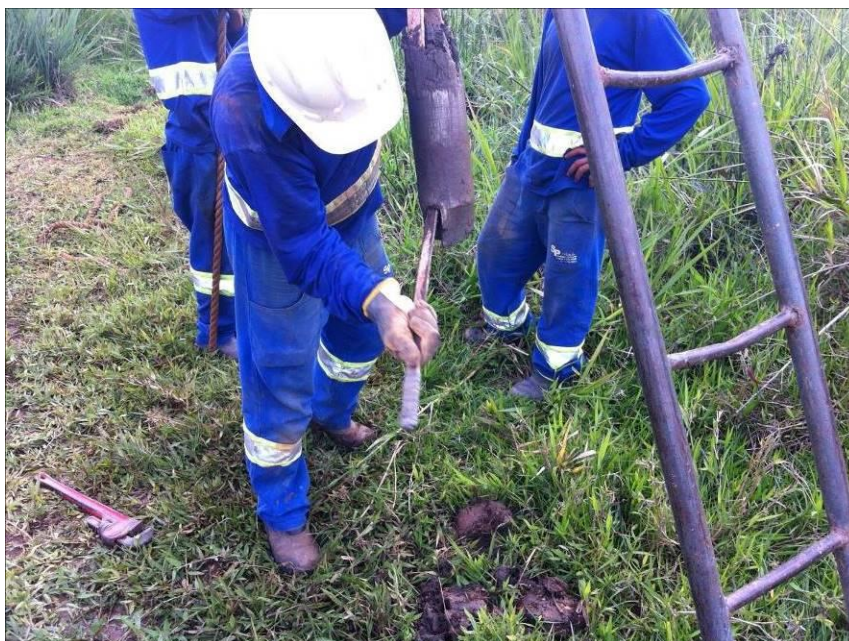
Foto 13: Recuperação de solo formado por argila orgânica durante a sondagem S-03 na AID do empreendimento junto à drenagem.
