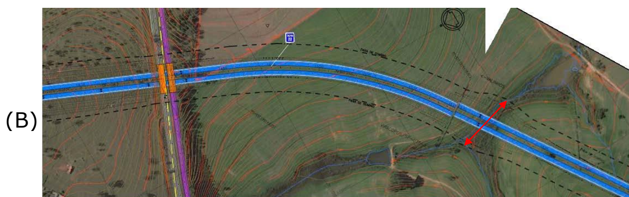
Figura 3.2.1-1: Alternativa tecnológica para o cruzamento do Prolongamento da SP-083 com a SP-324: (A) Passagem da SP-083 superior à SP-324 – devido à necessidade de alteamento dos encabeçamentos da PS, o aterro necessário na sequência do traçado seria de 4 bermas de equilíbrio sobre a drenagem (Afluente do Capivari-Mirim); e (B) Passagem da SP-083 inferior à SP-324 – o ajuste ao terreno conduziria ao aterro de apenas 2 bermas de equilíbrio sobre o mesmo curso d’água.
