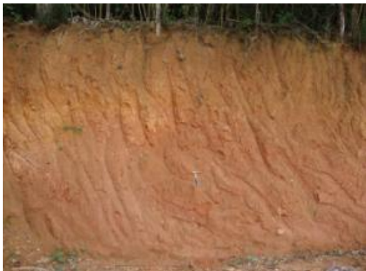
Foto 5.1.5 | Vista geral de talude de corte com perfil de solo de alteração gnaiss pertencente ao Complexo Amparo (PlaGM) na AID. Ponto PC-02. Coordenadas 316.697E e 7.438.891 N.
