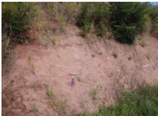
Foto 5.1.13 | Vista geral de talude de corte na beira da Estrada Municipal Natal Lorencini no limite entre a AID e ADA. Observa-se perfil de alteração de gnaiss pertencente ao Complexo Amparo (PlaGM). Ponto PC-65. Coordenadas 316.626 E e 7.440.214 N.
