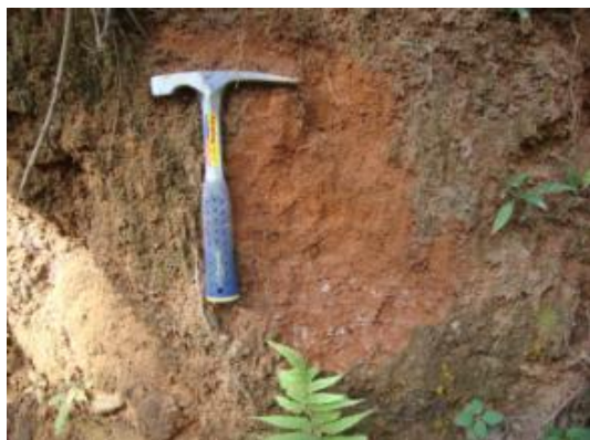
Foto 5.1.11 | Detalhe de perfil de solo em talude de corte na beira da estrada municipal JAR-189 no limite da AID e ADA. Observa-se resquícios de rocha alterada na base do martelo. Ponto PC-74. Coordenadas 316.470 E e 7.441.172 N.
