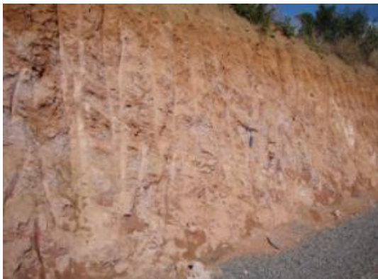
Foto 5.1.1 | Vista geral de talude de corte na beira da Estrada Municipal Natal Lorencini na AID. Observa-se perfil de alteração de gnaiss pertencente ao Complexo Amparo (PlaGM). Ponto PC-71. Coordenadas 318.447E e 7.441.453 N.
