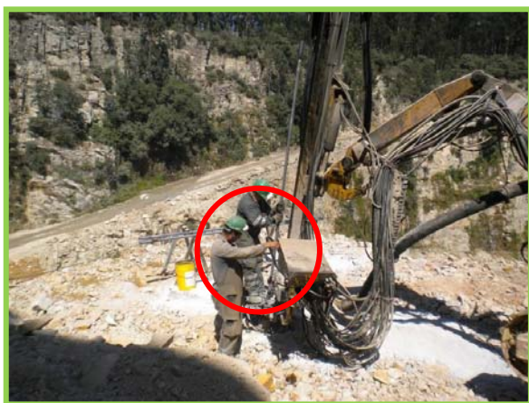
Realização de medições de vibrações transmitidas ao sistema Mão-Braço
