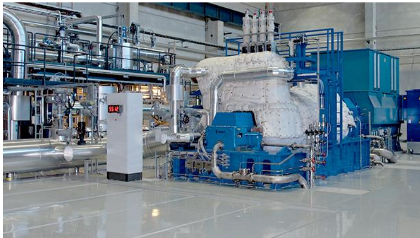
Figura 7.4.1.8.1 - Ilustração de Turbina a Vapor.
