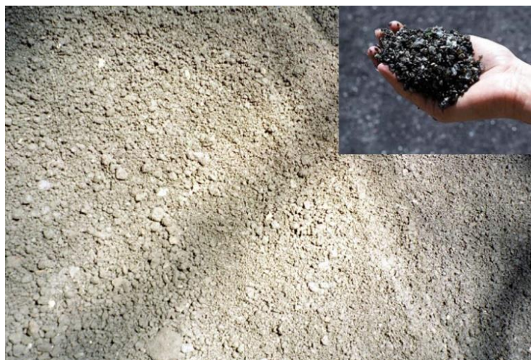
Figura 7.4.1.7-1 - Aspecto da Escória da Caldeira.
