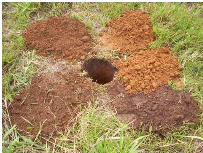
Foto 5-1. Separação por níveis artificiais de 20cm no furo de 100cm.
