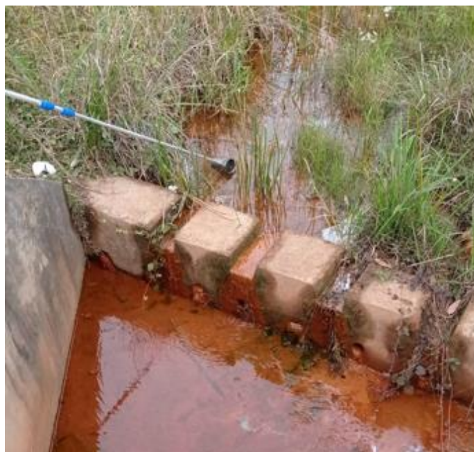
Figura 2 – Coleta de amostra no corpo hídrico definido como ponto 4.
