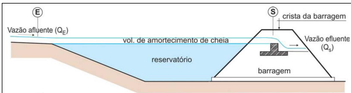
Figura 7.6 – Esquema típico de um barramento com vertedor de superfície.
