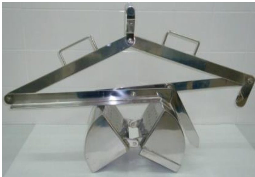
FIGURA 4: Amostrador de sedimento: Pegador Petersen
