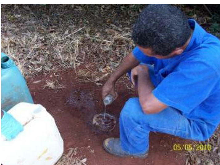
Foto 10. Ensaio de infiltração “in situ” sendo realizado na área pesquisada.
