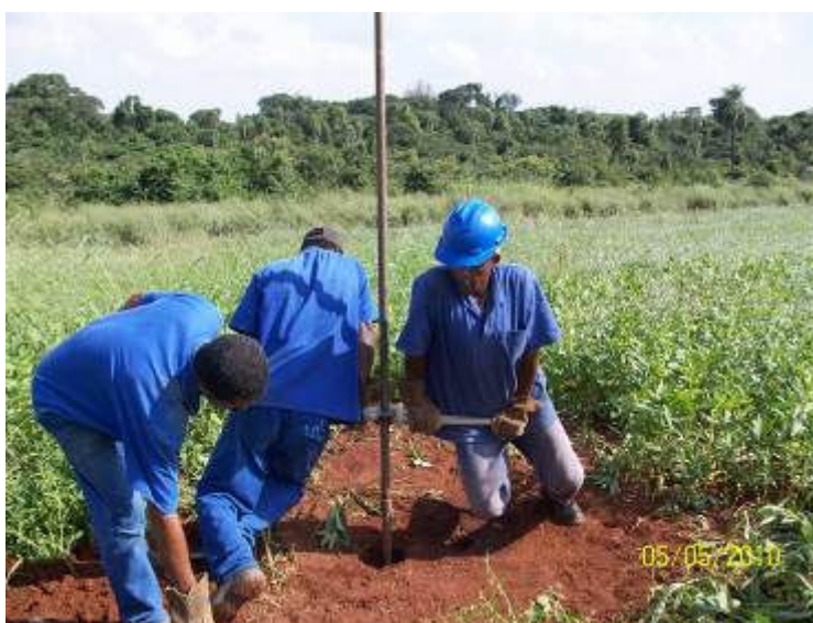
Foto 11. Sondagem para caracterização pedológica/litológica e investigação do N.A.
