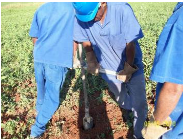
Foto 9. Sondagem para execução de ensaio de infiltração “in situ”.
