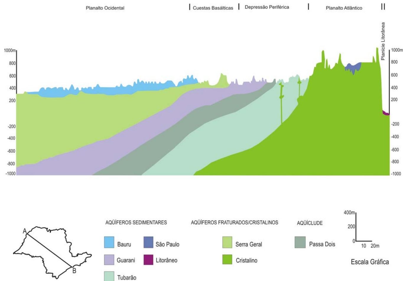
Figura 8.1.1.7-1. Seção hidrogeológica esquemática do Estado de São Paulo (modificado DAEE, 2005).
