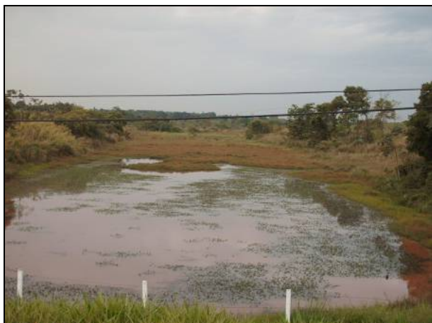
Figura 8.1.3.2-131. Travessia do Córrego do Cascalho com planície aterrada e possível afloramento de diabásio. Recomendação de travessia por furo direcional.
