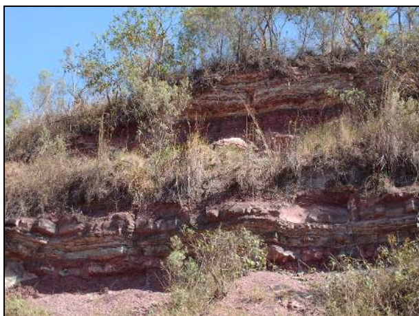
Figura 8.1.3.2-150. Detalhe de afloramento de siltitos e arenitos silicificados da Formação Corumbataí (rocha muito dura), problemas com escavabilidade, no local descrito na figura anterior.
