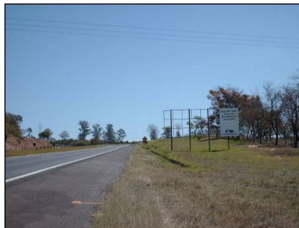
Figura 8.1.3.2-152. Vista geral do trecho, entre as coordenadas 225.945 E/7.529.778 N a 225.184 E/7.530.535 N, com afloramentos de solo silto argiloso da Formação Corumbataí. Grau de escavabilidade de material brando.
