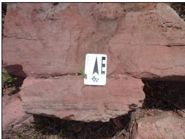
Figura 8.1.3.2-359. Detalhe de bloco de diabásio no local citado na figura anterior. Possíveis problemas de escabilidade. Local potencial para ocorrência de escorregamento (trecho: 774.289E/7.537.138N a 771.917E/7.536.886N).
