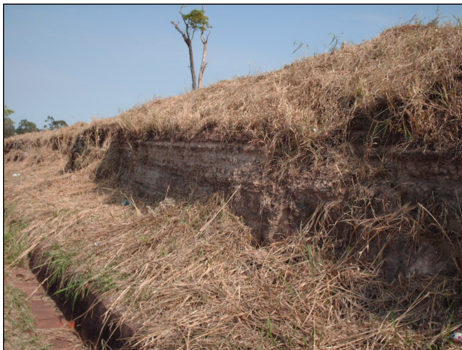
Figura 8.1.2.2-7. Ponto de afloramento de arenitos acastanhado, fino a muito fino, com intercalações de lamito arenoso compacto da Formação Adamantina. Apresenta grau de escavabilidade de rocha branda, contudo forma solos arenosos friáveis e extremamente suscetíveis a erosão (região de Guararapes).
