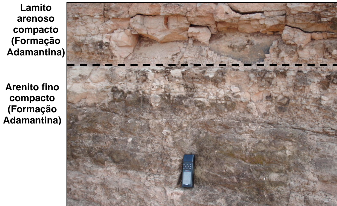
Figura 8.1.2.2-8. Detalhe do afloramento de arenito fino e lamito arenoso compacto da Formação Adamantina (mesmo local da foto anterior).
