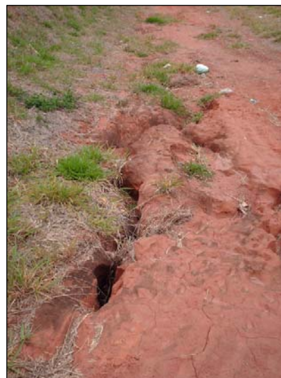
Figura 9.3-8. Detalhe de sulcos erosivos que ocorrem na AID no solo da Formação Adamantina, nas margens da Rodovia SP – 320 (Rodovia Euclides da Cunha), pista norte, na região de Mirassol.
