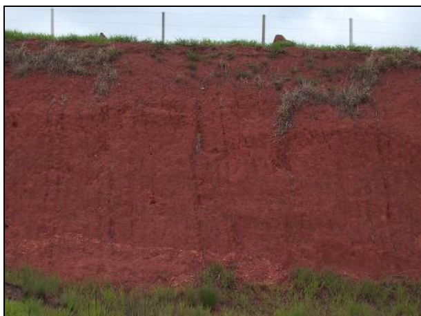
Figura 8.1.3.2-68. Detalhe de perfil de alteração de diabásio que ocorrem ao longo da Rodovia SP - 332.
