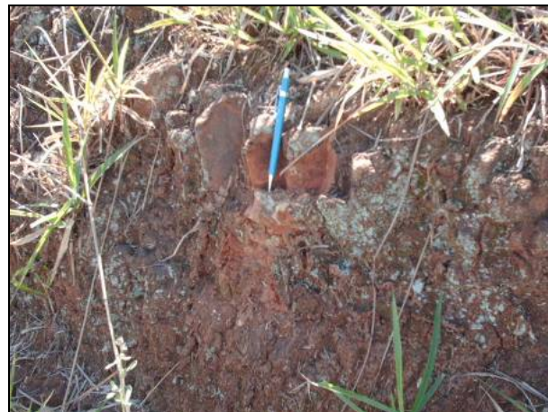
Figura 8.1.3.2-173. Detalhe de solo de alteração do basalto que ocorre na Serra dos Padres, onde também é possível notar a presença de matacões e blocos rochosos no perfil do solo.
