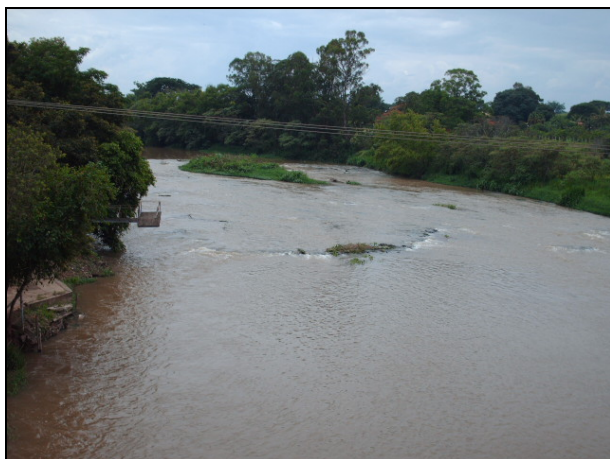
Figura 8.1.2.5-12. Calha do Rio Jaguari. Observa-se diabásio aflorando no leito e depósito de assoreamento. Recomendação de furo direcional ou aérea.
