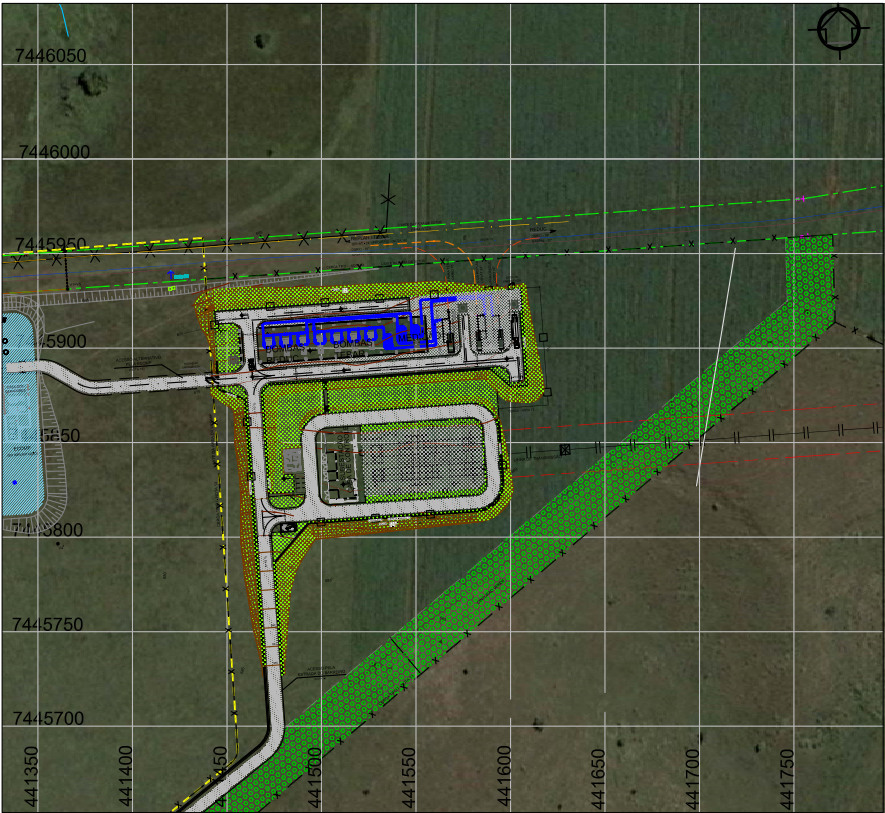
LAY OUT DA ESTAÇÃO DE BOMBEAMENTO DE TAUBATÉ EM IMAGEM DE SATÉLITE Escala 1:4.000
