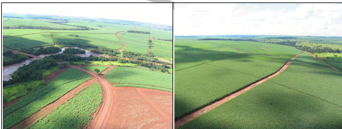
Foto VI.3.2.1-8 – Traçado do duto desprovido de vegetação. Apesar de estar em área com pouca declividade, isto pode potencializar processos erosivos e assoreamento de drenagem. Foto VI.3.2.1-9 – Traçado do duto desprovido de vegetação, podendo potencializar processos erosivos. Coordenadas 20256/7750720.
