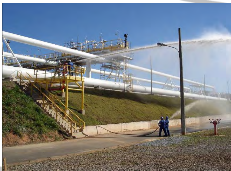
Foto II.4.3.4-9 - Testes das instalações do sistema de proteção e combate a incêndio Fonte: PETROBRAS
