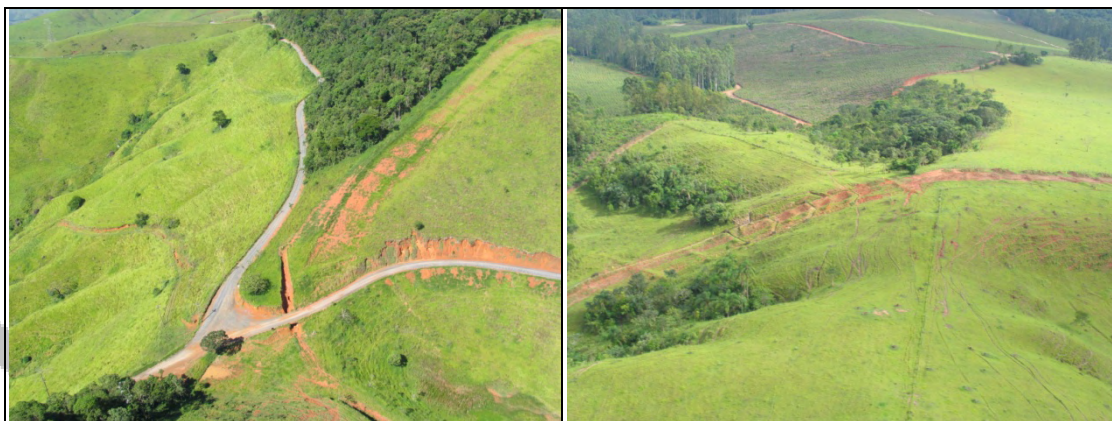
Foto VI.3.2.1-6 – Início de ravinamento próximo ao eixo do duto. Será necessária intervenção imediata. Coordenada UTM 391553/7446051 e Foto VI.3.2.1-7 – área com intenso pisoteio de criação. Poderá potencializar processos erosivos. Coordenada UTM 437333/7443476.
