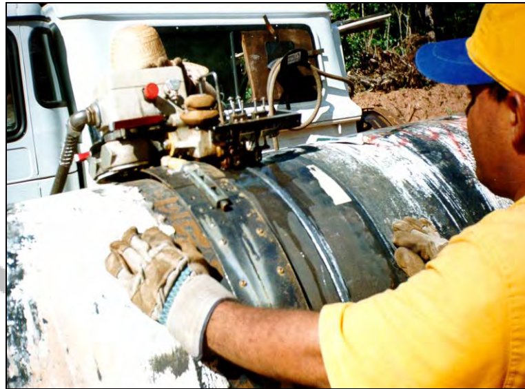
Foto II.4.3.3.1-6 - Teste de inspeção da junta soldada por ultra-som.
