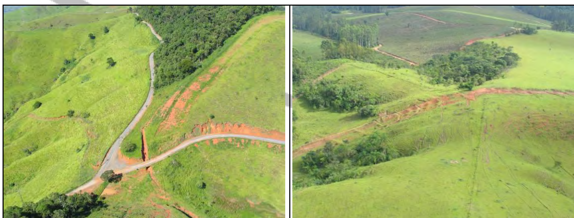
Foto V.1.5.3-1 – Início de ravinamento próximo ao eixo do duto. Será necessária intervenção imediata. Coordenada UTM 391553/7446051 e Foto V.1.5.3-2 – área com intenso pisoteio de criação. Poderá potencializar processos erosivos. Coordenada UTM 437333/7443476.
