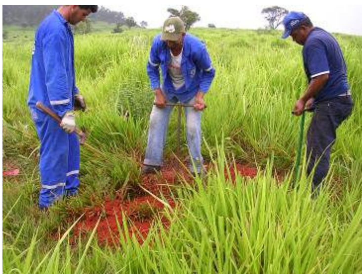
FOTO 16. Sondagem a trado sendo executada para determinação do nível freático (aqüífero livre), para caracterização do perfil litológico-pedológico e determinação de ensaios geotécnicos de infiltração in situ.
