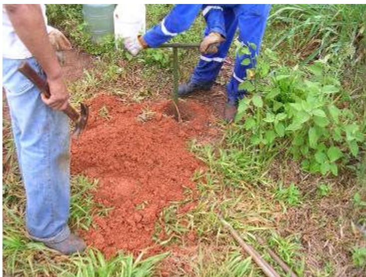
FOTO 18. Sondagem a trado sendo executada com 5m de profundidade apresentando solo vermelho, de alteração de granito, característico da área.
