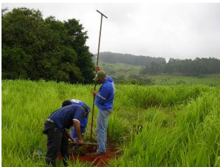
FOTO 15. Execução de sondagem para caracterização litológica e investigação do nível d'água.
