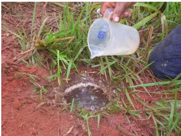
FOTO 17. Execução de ensaio de infiltração in situ.
