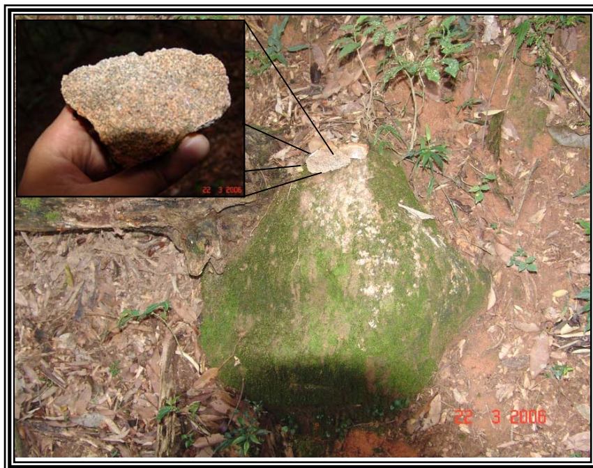
Figura 4.2.3.3-2: Bloco granítico de dimensões decimétricas. Em destaque composição granítica fina, equigranular. Ocorrência: porção Oeste do terreno
