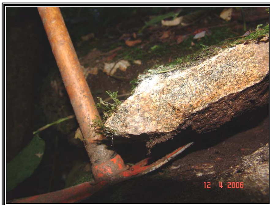
Figura 4.2.3.3-4: Detalhe de granítico equigranular apresentando fenocristais de feldspato potássico e quartzo.
