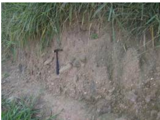
Foto 7.2.3.3.2. - Cobertura coluvionar, observar a disposição caótica dos seixos e fragmentos dispersos em meio a um solo arenoso.
