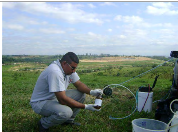
Foto IV.2.5.5.8-2 – Coleta de água subterrânea pelo método Low Flow (PM1)
