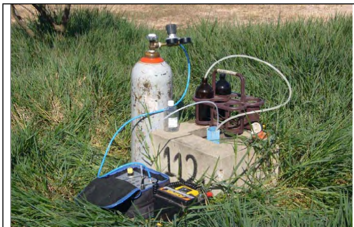
Foto III.3.3.12-3 – Exemplo de monitoramento ambiental realizado na área do Delta A: amostragem de água subterrânea em PM à jusante do aterro
