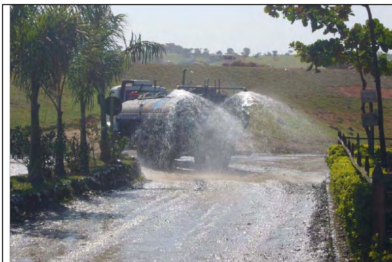
Foto III.3.3.19-1 – Serviços rotineiros de umectação das superfícies dos acessos internos e áreas de descarga do aterro para controlar a emissão de particulados
