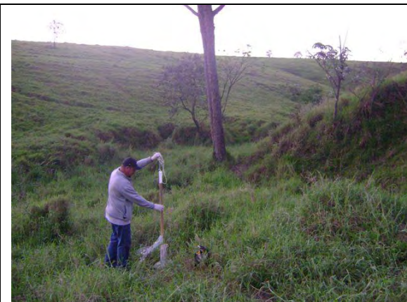
Foto IV.2.5.5.8-6 – Coleta de água subterrânea efetuada por bailer no PM3
