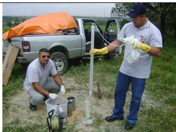
Foto IV.2.5.5.8-10 – Coleta de água subterrânea por bailer PM5
