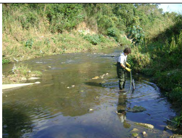
Foto IV.2.5.6-12 – vista da coleta de sedimento no rio Piçarrão.
