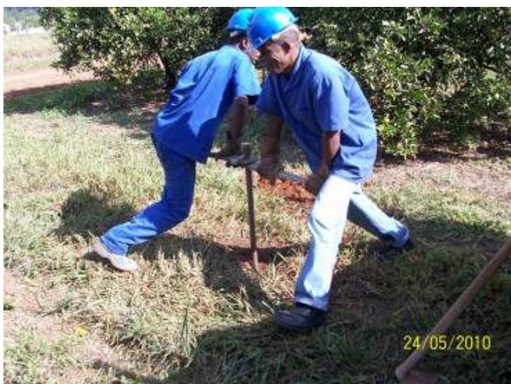
FOTO 10. Sondagem para execução de ensaio de infiltração “in situ”.
