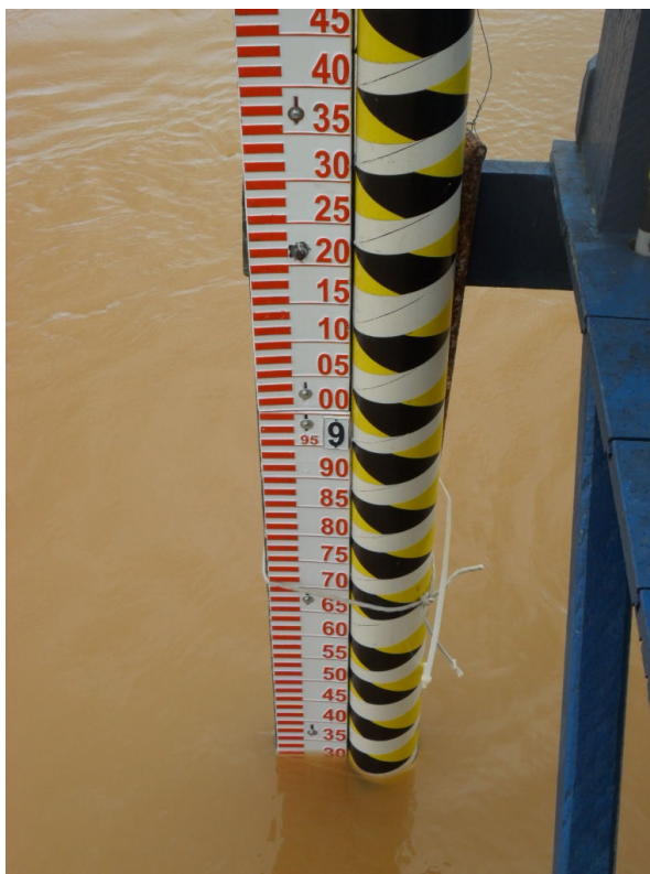
FIGURA 7. Modelo de régua a ser utilizada para medir o nível de sedimento. FONTE: PINTO, 2011.
