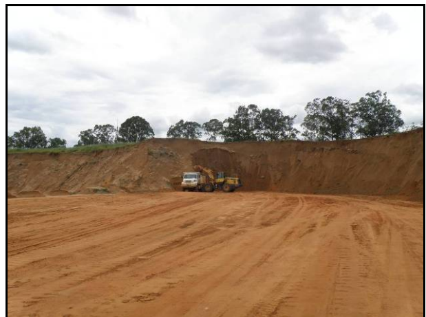
FOTO 4.2.1.2 – Carregamento em caminhão basculante que realiza o transporte da areia da frente de lavra até a unidade industrial, de modo análogo ao previsto para as “áreas IPT”.
