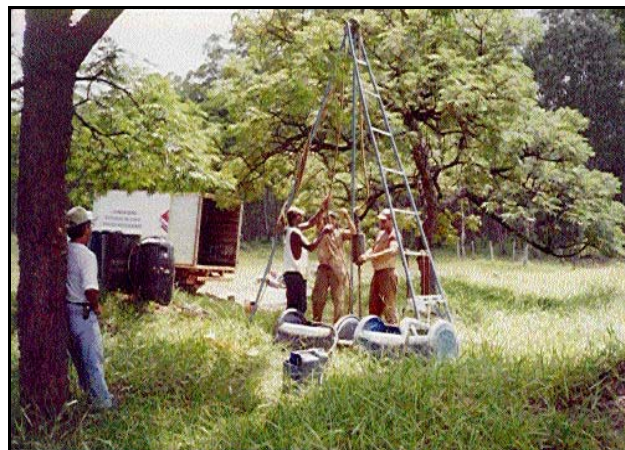
FOTO 4.1.2.2 – Execução de serviços de sondagem na poligonal DNPM 821.613/2000.
