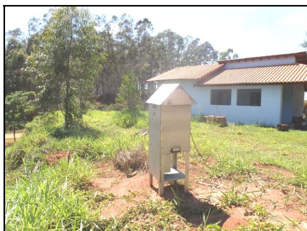
FOTO 5.2.8.2 - Ponto HV2 de monitoramento da concentração de material particulado, instalado próximo ao sítio do Sr. José Carlos.
