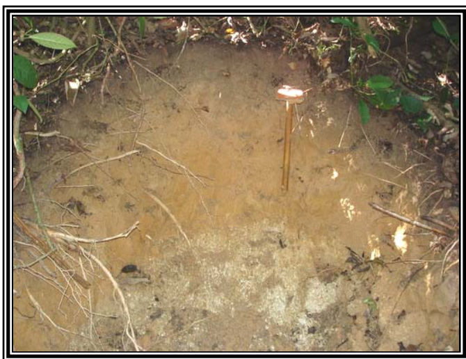
FIGURA - 4.4-5 - Vista de bloco granítico alterado, apresentando coloração cinza clara. Nota-se ainda a evolução do processo de alteração da rocha.
