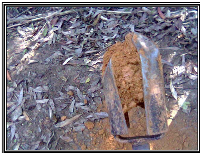
Figura 4.6-2: Vista de Argissolo amostrado a partir de tradagem manual.
