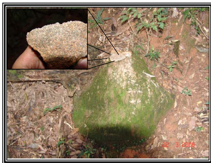
Figura 4.4-3: Bloco granítico de dimensões decimétricas. Em destaque composição granítica fina, equigranular. Ocorrência: porção Oeste do terreno
