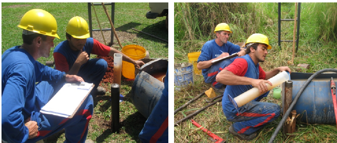
Figuras 2.3.2.2-4 e 2.3.2.2-5. Fotografia da execução de ensaios de permeabilidade na gleba do loteamento Residencial SETE LAGOS, Itatiba, SP.
