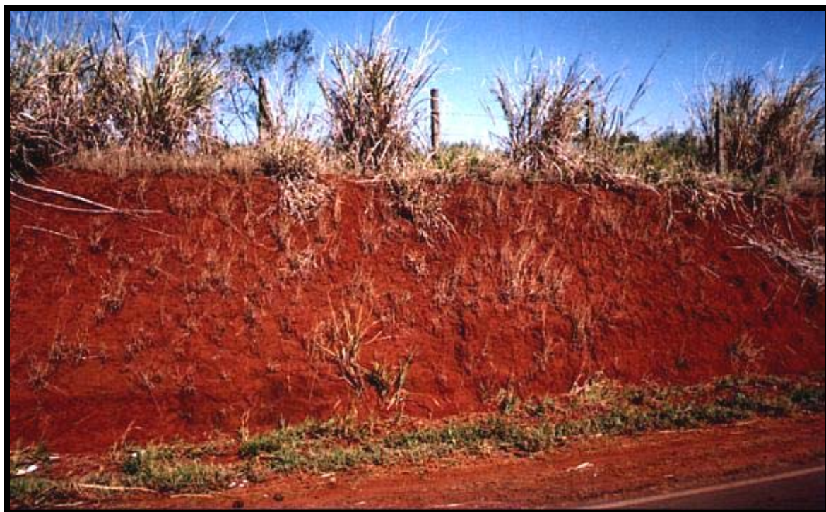
Figura 7.2.48 – Foto de perfil do solo residual, argilo arenoso, com 4 metros de espessura em vertente convexa de colina ampla a nordeste da área. A sudeste da área de intervenção.
