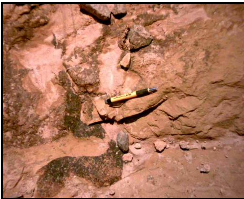
Figura 7.2.30 – Afloramento de argilito maciço com níveis de arenitos, com películas de óxido nos planos de fraturas. Área de entorno a oeste.
