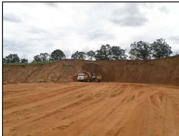
FOTO 4.2.2 – Carregamento em caminhão basculante que realiza o transporte da areia da frente de lavra até a unidade industrial, de modo análogo ao previsto para as “áreas IPT”.
