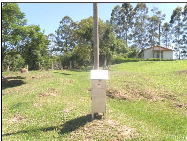
FOTO 5.2.8.3 - Ponto HV3 de amostragem de material particulado no ar instalado, na residência do sr. Adair.
