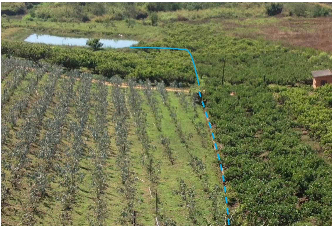
Foto 2: Atualmente, a descida da drenagem está canalizada até a travessia com a estrada rural. A jusante da estrada, o curso d'água está represado.
