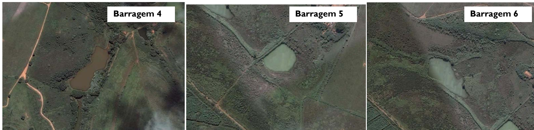
Figura 6.2.3-I – Barramentos pré existentes na gleba SETE LAGOS sem capacidade de amortecimento das vazões de cheia após impermeabilização do terreno, Itatiba, SP.
