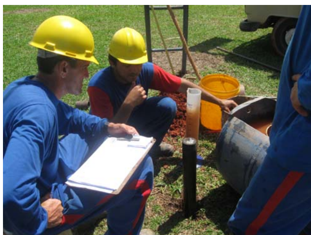
Fotos 1 e 2. Execução de ensaios de permeabilidade
