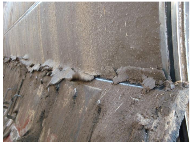
Foto 34 – Detalhe da raspagem da torta de filtro acumulada.
