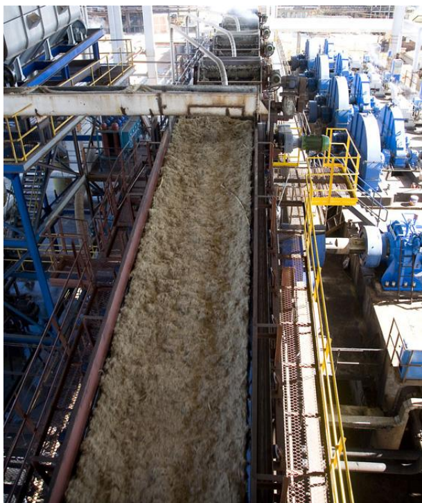
Foto 27 – Esteiras transportando as fibras da cana para as moendas.
