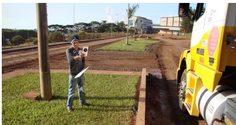
Foto 50 – Funcionário verificando emissão de fumaça preta com Escala de Ringelmann.
