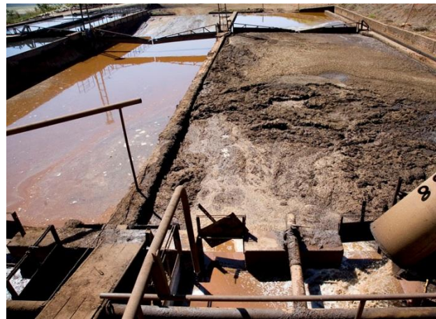
Foto 26 – Caixas de decantação de água de lavagem de cana.
