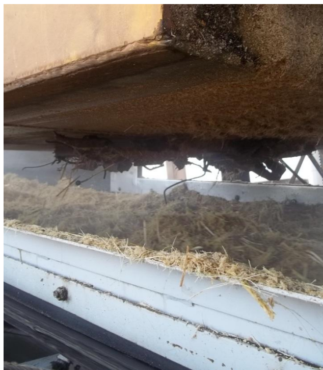
Foto 28 – Eletroímã em ação separando materiais ferrosos das fibras de cana.
