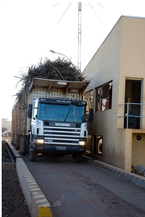
Foto 19 – Pesagem dos caminhões de cana na balança.
