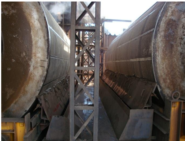
Foto 33 – Filtros rotativos à vácuo.
