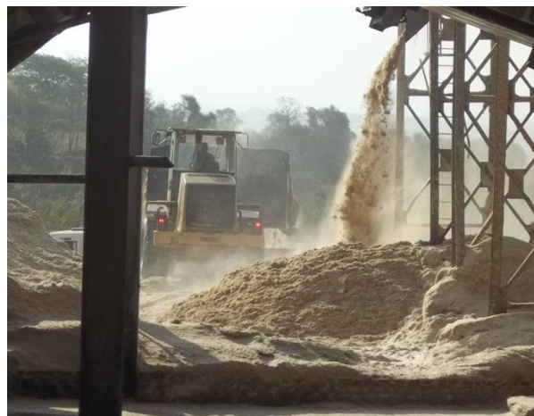
Foto 31 – Bagaço sendo depositado por esteiras no pátio (pá carregadeira ao fundo).
