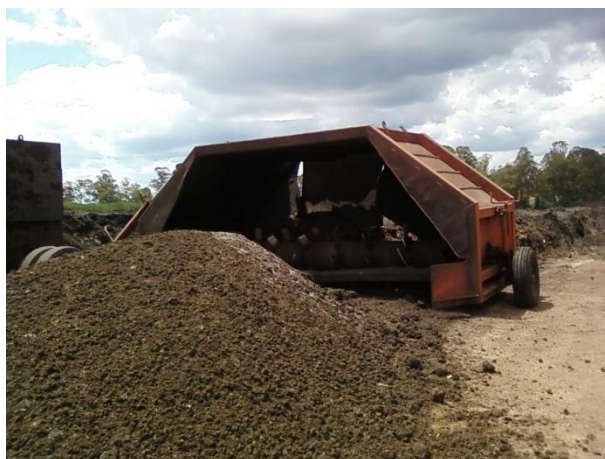
Foto 3 – Compostador misturando torta de filtro e cinzas da caldeira.
