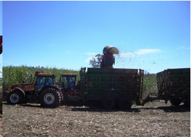
Foto 16 – Trator com carretas transbordo sendo carregadas com cana picada.
