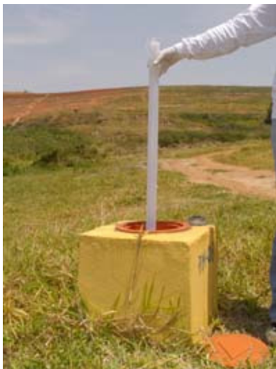
Foto 01 - Coleta de água subterrânea no PM-08 com bailer comum
