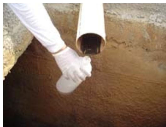
Foto 06 - Coleta de percolado na caixa coletora.
