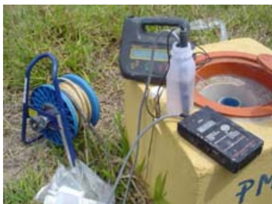
Foto 03 - Equipamentos utilizados em campo para medições físico e químicas
