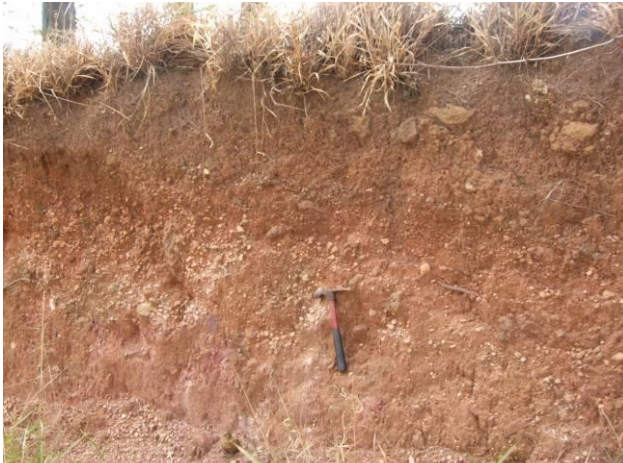
Fotos 21 e 22 - Conglomerado constituído por arenito fino a grosso siltoso com matriz argilosa, e seixos de quartzo arredondados e angulosos que constituem a Formação Itaqueri, recobertos por material areno-argiloso com blocos e fragmentos angulosos de laterita. 549 / 552 (0197356 x 7508720).
