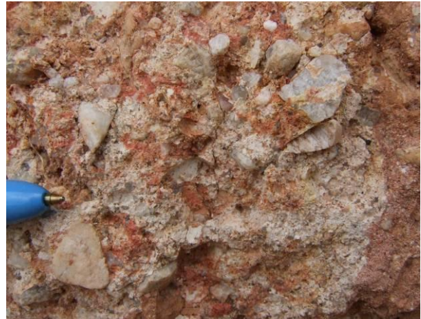
Fotos 21 e 22 - Conglomerado constituído por arenito fino a grosso siltoso com matriz argilosa, e seixos de quartzo arredondados e angulosos que constituem a Formação Itaqueri, recobertos por material areno-argiloso com blocos e fragmentos angulosos de laterita. 549 / 552 (0197356 x 7508720).
