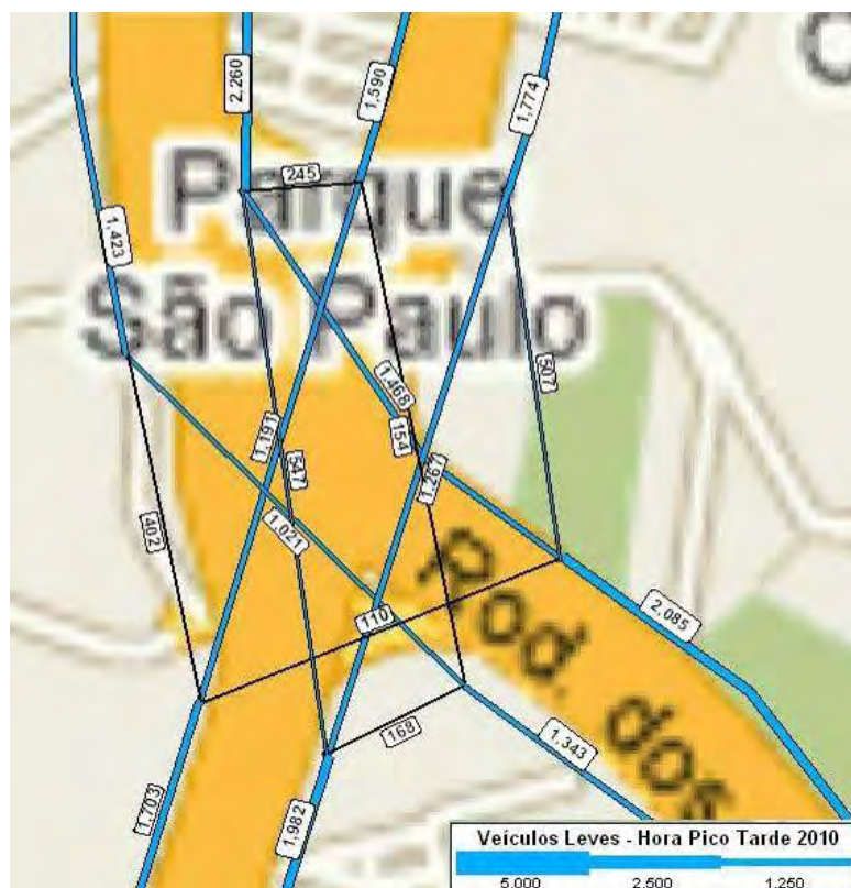
Figura 3.4b: Detalhes das Interseções – Interseção 2: SP075 x SP348 Rede Atual + Veículos Leves na Hora Pico Tarde (2010)
