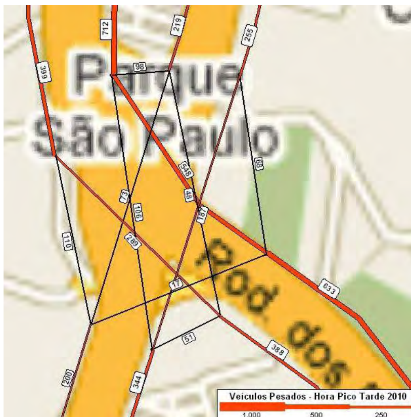
Figura 3.2b: Detalhes das Interseções – Interseção 2: SP075 x SP348 Rede Atual + Veículos Pesados na Hora Pico Tarde (2010)
