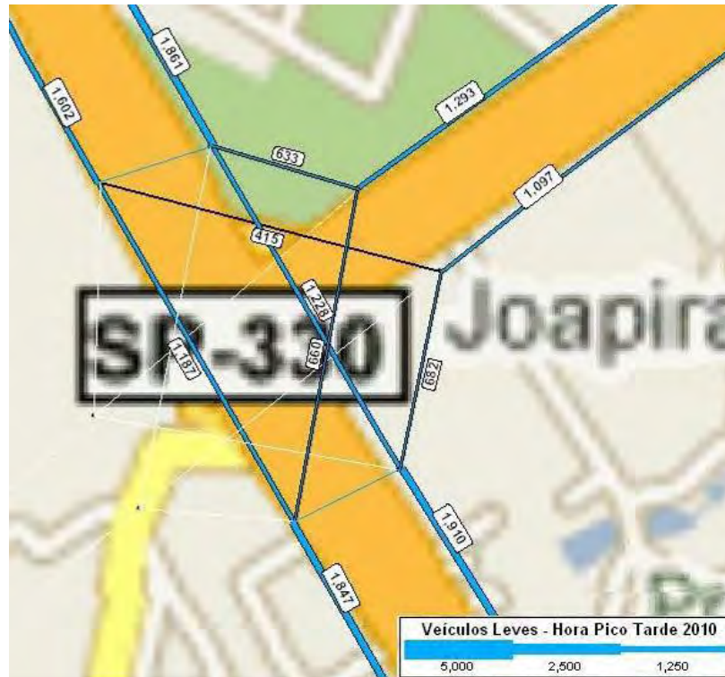
Figura 3.4a: Detalhes das Interseções – Interseção 1: SP083 x SP330 Rede Atual + Veículos Leves na Hora Pico Tarde (2010)
