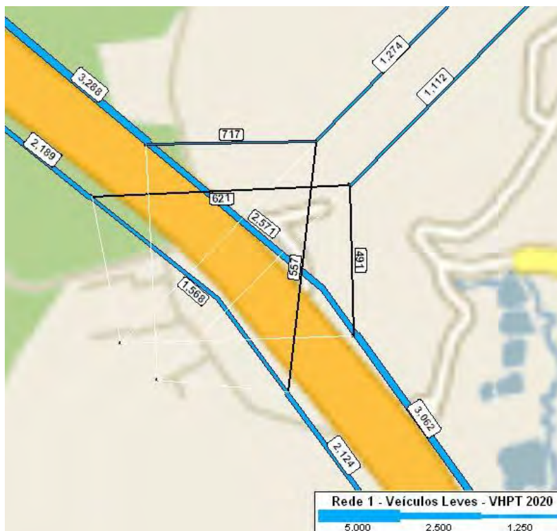
Figura 4.4b: Detalhes das Interseções – Interseção 4: SP083 x SP348 Rede 1 – Veículos Leves – Hora Pico Tarde – 2020
