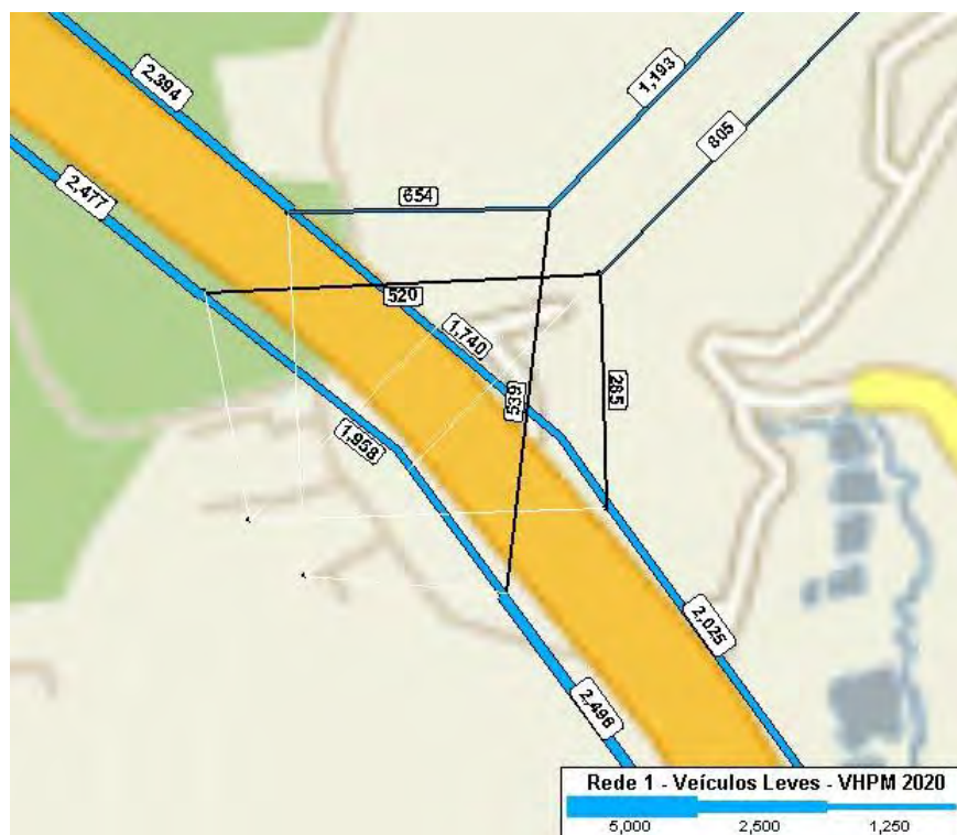
Figura 4.2b: Detalhes das Interseções – Interseção 4: SP083 x SP348 Rede 1 – Veículos Leves – Hora Pico Manhã – 2020
