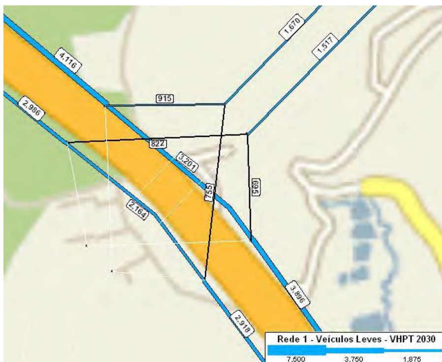
Figura 4.12b: Detalhes das Interseções – Interseção 4: SP083 x SP348 Rede 1 – Veículos Leves – Hora Pico Tarde – 2030
