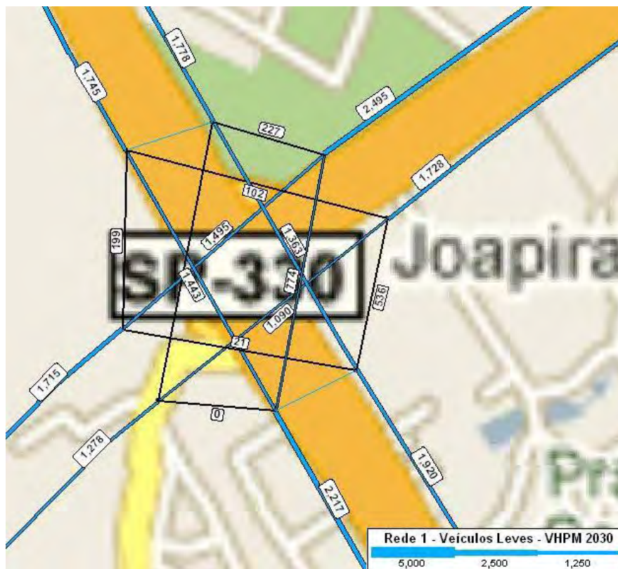
Figura 4.10a: Detalhes das Interseções – Interseção 1: SP083 x SP330 Rede 1 – Veículos Leves – Hora Pico Manhã – 2030
