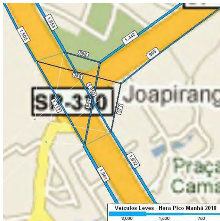
Figura 3.2a: Detalhes das Interseções – Interseção 1: SP083 x SP330 Rede Atual + Veículos Leves na Hora Pico Manhã (2010)
