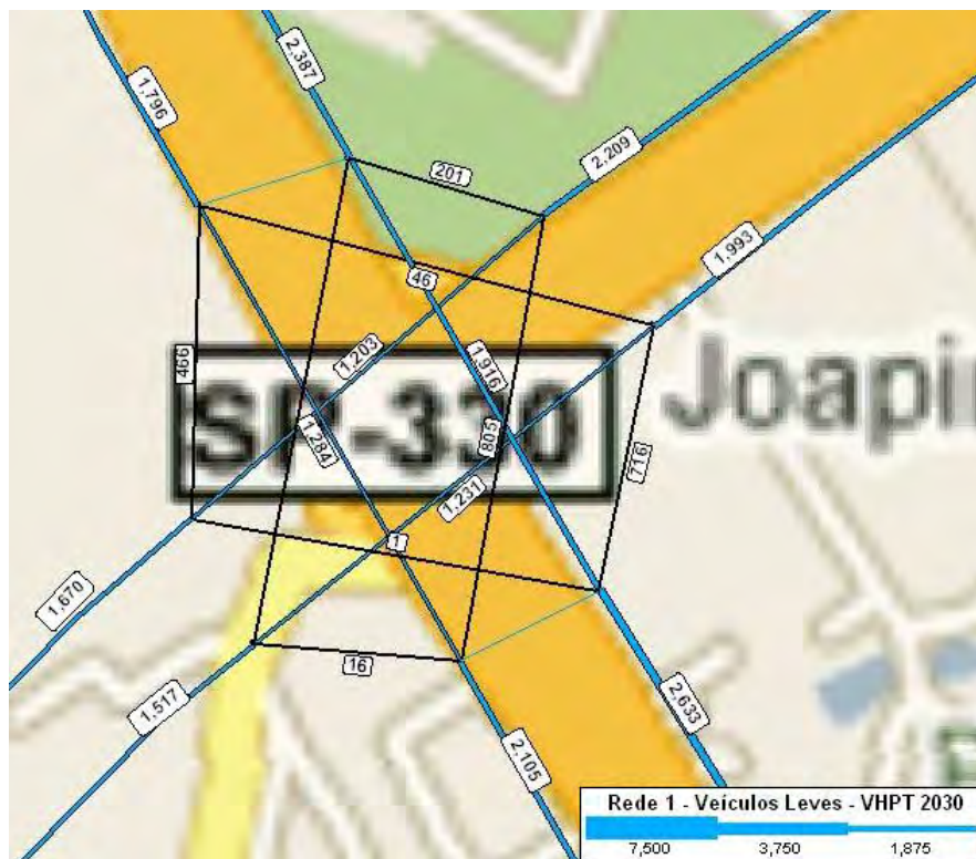
Figura 4.12a: Detalhes das Interseções – Interseção 1: SP083 x SP330 Rede 1 – Veículos Leves – Hora Pico Tarde – 2030
