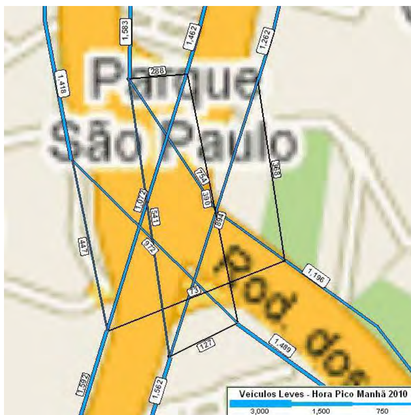
Figura 3.2b: Detalhes das Interseções – Interseção 2: SP075 x SP348 Rede Atual + Veículos Leves na Hora Pico Manhã (2010)
