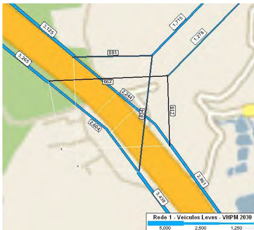
Figura 4.10b: Detalhes das Interseções – Interseção 4: SP083 x SP348 Rede 1 – Veículos Leves – Hora Pico Manhã – 2030
