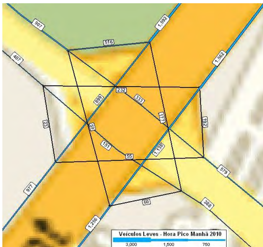
Figura 3.2c: Detalhes das Interseções – Interseção 3: SP075 x SP324 Rede Atual + Veículos Leves na Hora Pico Manhã (2010)
