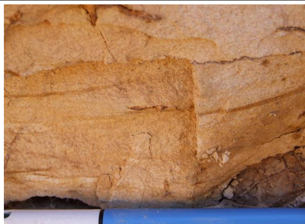
Foto 04: Siltito com areia muito fina alterado que sustenta os terrenos Colinosos na Gleba B.
