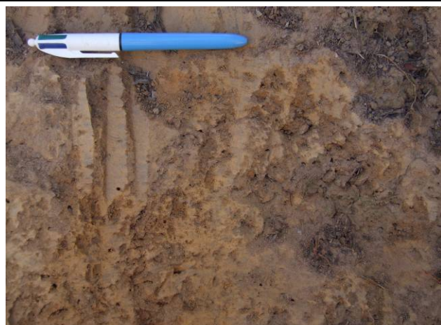
Foto 06: Solo residual constituído por areia fina e siltosa que da origem a Argissolos Vermelho-Amarelo e/ou Cambissolos Háplicos geralmente de textura média.
