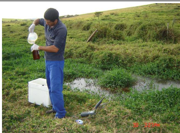
Foto 05: Coleta de água no Ponto de Amostragem 01 (montante do reservatório).
