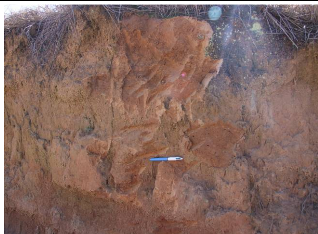
Foto 21: Arenitos finos e siltitos alterados do Subgrupo Itararé e ARGISSOLOS VERMELHO-AMARELO + CAMBISSOLOS HÁPLICOS ambos textura média, que caracterizam os Terrenos Colinosos na Gleba C.
