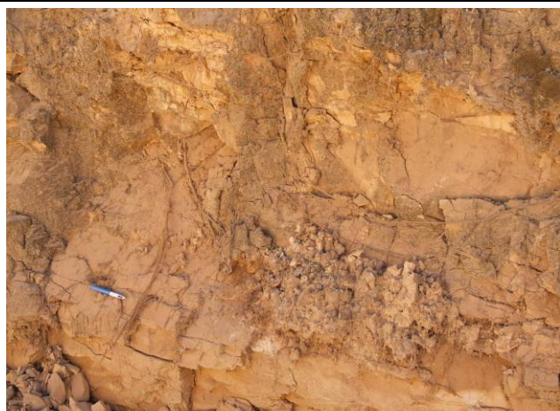
Foto 05: Siltito com areia muito fina alterado e fraturado do Supergrupo Itaré que sustenta os terrenos Colinosos na Gleba B.
